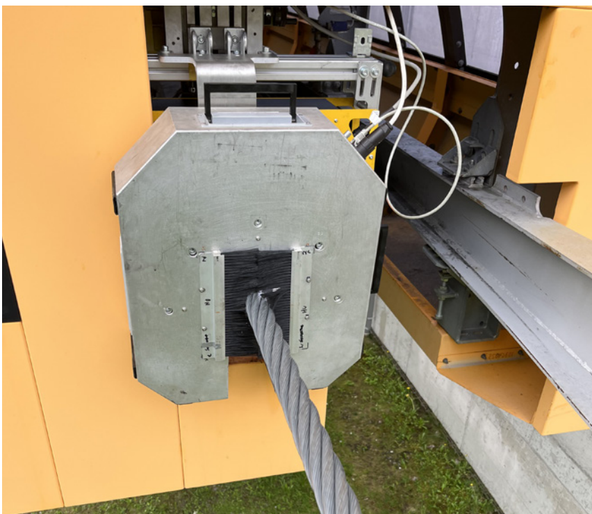
Das visuelle Seilprüfsystem im Einsatz
