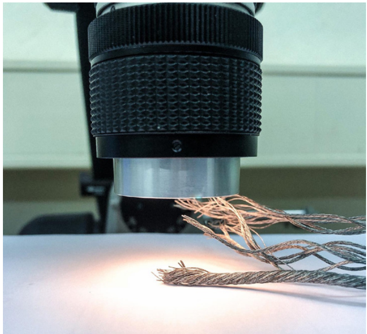
Mit dem Digitalmikroskop sind hochauflösende Aufnahmen von Drahtbruchenden möglich
