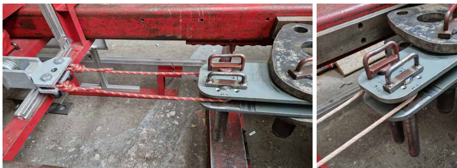
Versuchsaufbau von Zugversuchen an dynamischen Bergseilen über ‚scharfe‘ Kanten (hier: Rundung mit Radius 17,5 mm)
