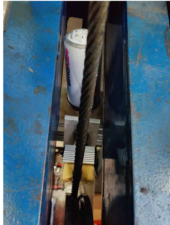
Versuchsaufbau zur Bestimmung der Effekte zur Seilpflege; Einbau in die Biegemaschine 13
