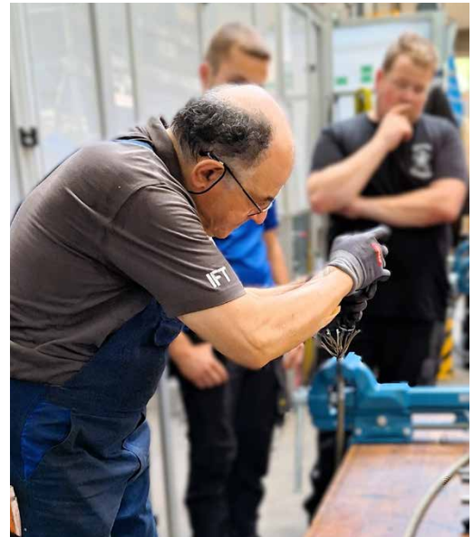
Vorbereiten des Drahtseils für den Verguss
