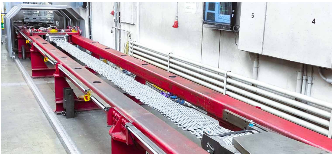
Belastungstests des Bandseilhebebands Iron Veins auf der Zugprüfmaschine am IFT
