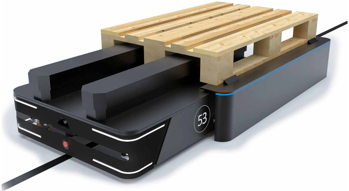
Beispiel für ein Unterfahr-FTF zum Transport von Paletten Bild: https://logiklick.io/systems/carrybots-herbie-xl
