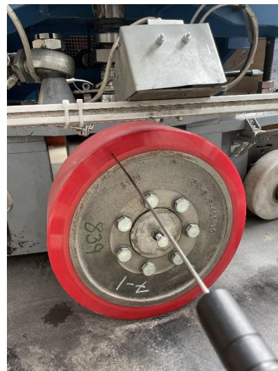
Taktile Temperaturmessung im Inneren der Bandage und berührungslos auf der Lauffläche mittels Pyroskop
