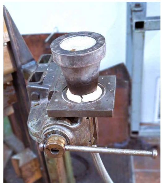
Seilhülse mit Metallverguss
