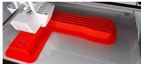
3D-Druck des Seitenradhalters mit Lamellenfedern
