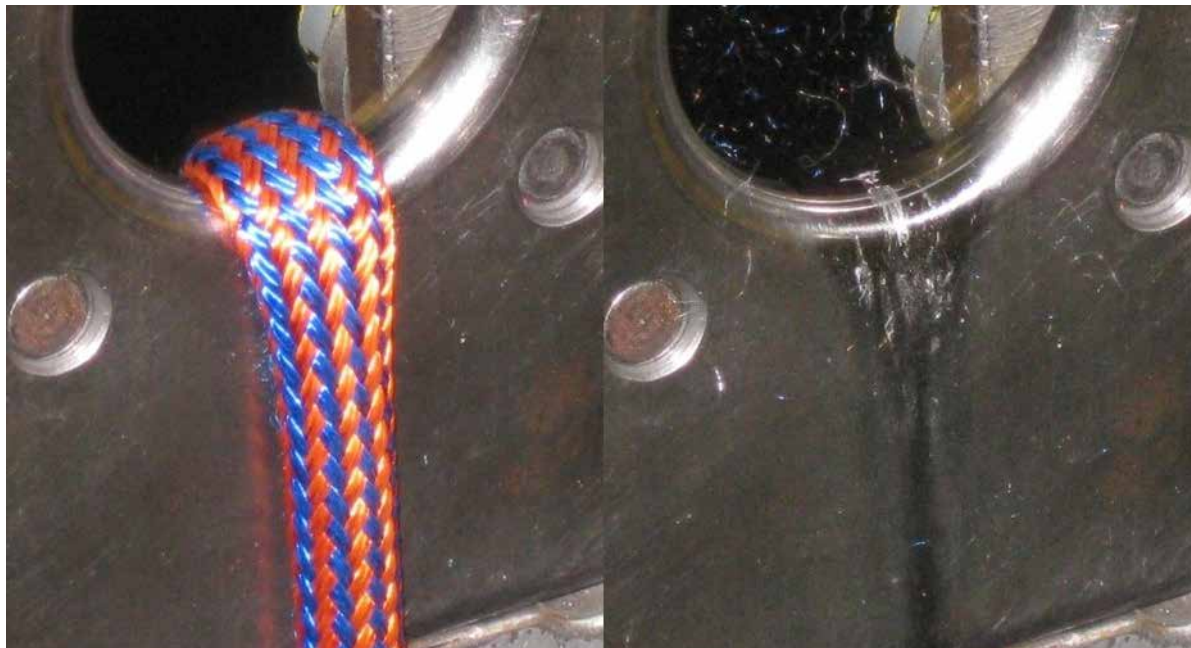
Seilbruch nach Fallprüfungen
