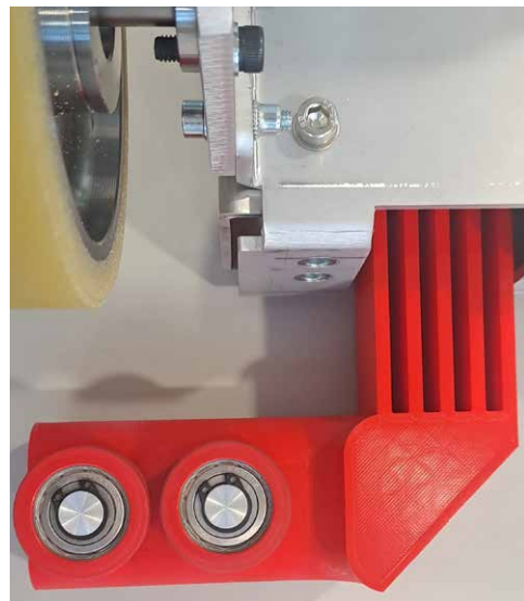
3D-gedruckter Seitenradhalter mit Lamellenfedern für die flexible Anbindung der Seitenräder
