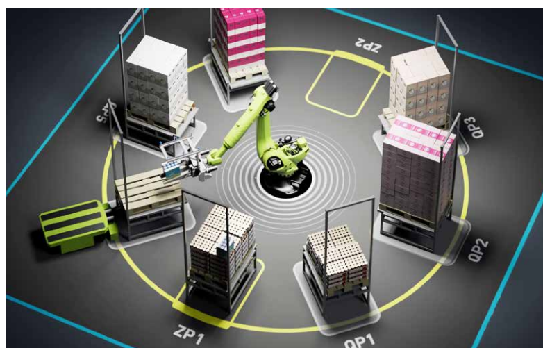
Kommissionierzelle mit stationärem Roboter und FTF
