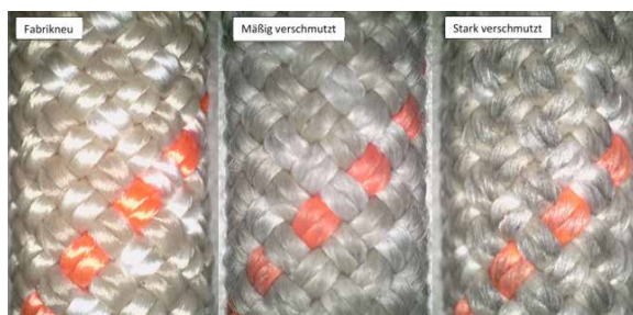
Seile in unterschiedlichen Gesamtzuständen
