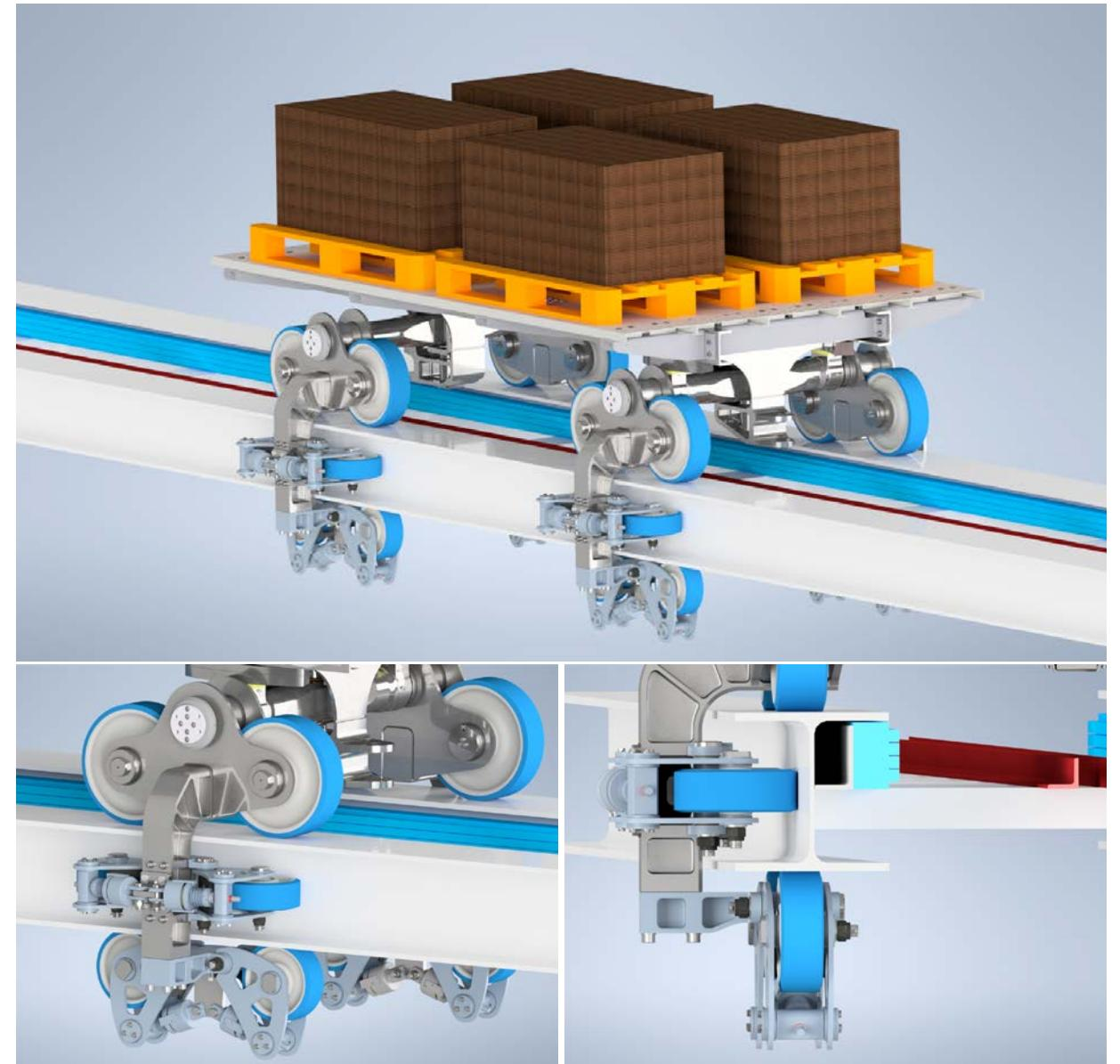
Als Anwendungsbeispiel für das adaptive Fahrwerk im intralogistischen Kontext wurde ein Transportfahrzeug entworfen, das den Transport von vier Euro-Paletten mit einer Nutzlast von insgesamt bis zu 3000 kg ermöglicht. Über eine Kupplung lässt sich ein Antriebsfahrzeug, ebenfalls mit adaptivem Fahrwerk, ankoppeln.
