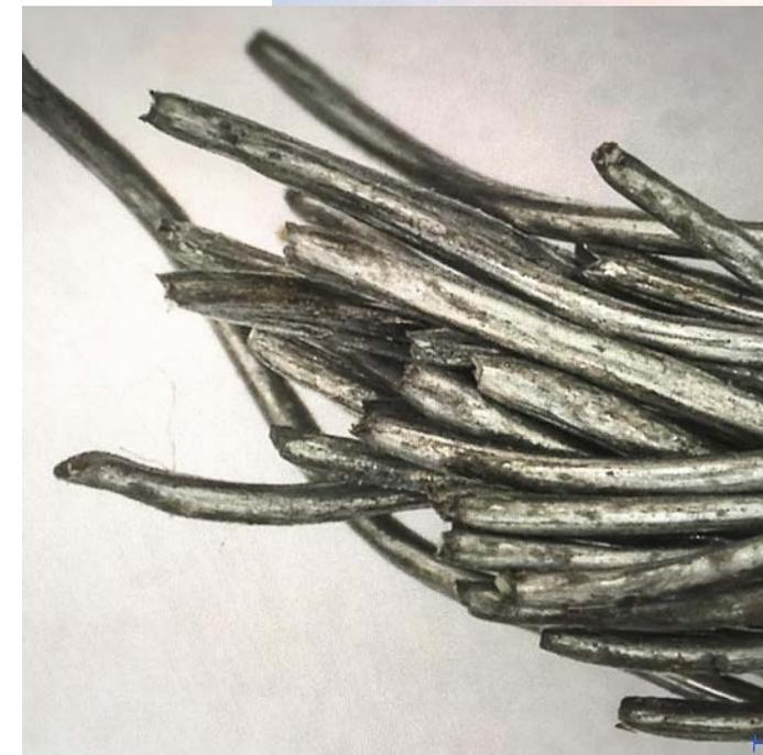
*Digitalmikroskope ermöglichen hochauflösende Aufnahmen der Drahtbruchenden*
