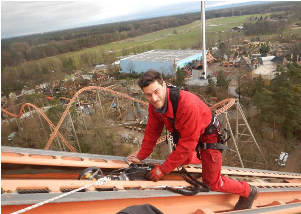
Seilkonstruktionen von Fahrgeschäften werden vom Prüfteam des IFT magnetinduktiv geprüft
