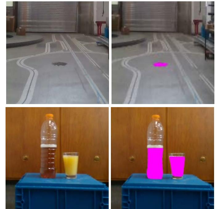
Erkennung von Pfützen und Füllständen in Gefäßen (Quelle: IFT)
