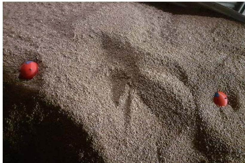
Erprobung der entwickelten Sensorkugeln zur Überwachung in Getreide
