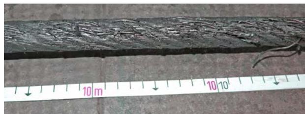
Lage der Seilschäden wird eingemessen
