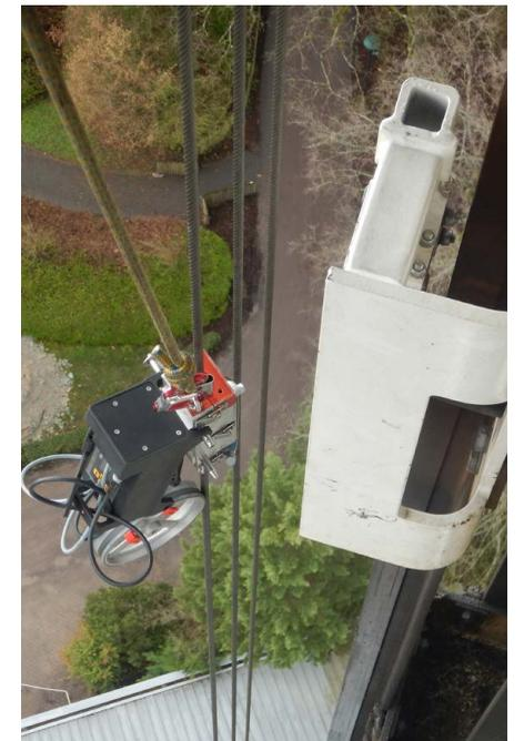
Magnetinduktive Prüfung der Hubseile des Freefall-Towers im Holidaypark in Hassloch
