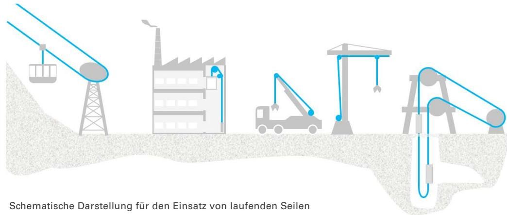
Schematische Darstellung für den Einsatz von laufenden Seilen
