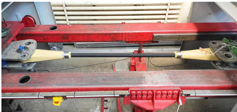
HIKE-Seilendverbindung im Zugversuch
