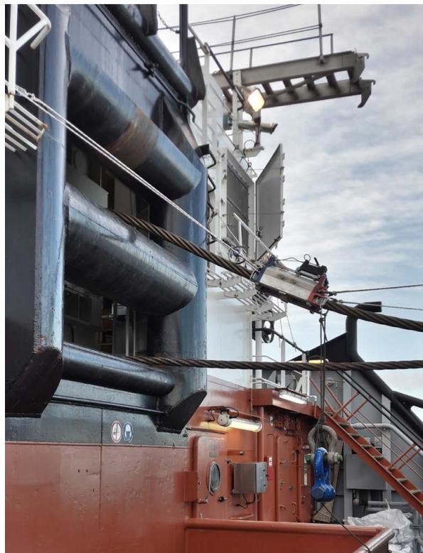
Magnetinduktive Seilprüfung der Stahldrahtseile
