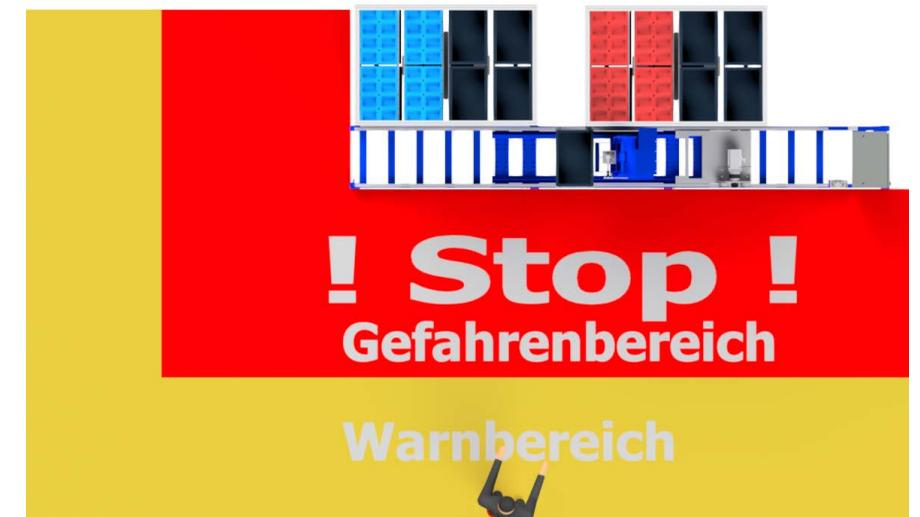
Flexible Zugangsabsicherung als „shared-safety-Funktion“ zwischen den beteiligten Komponenten
