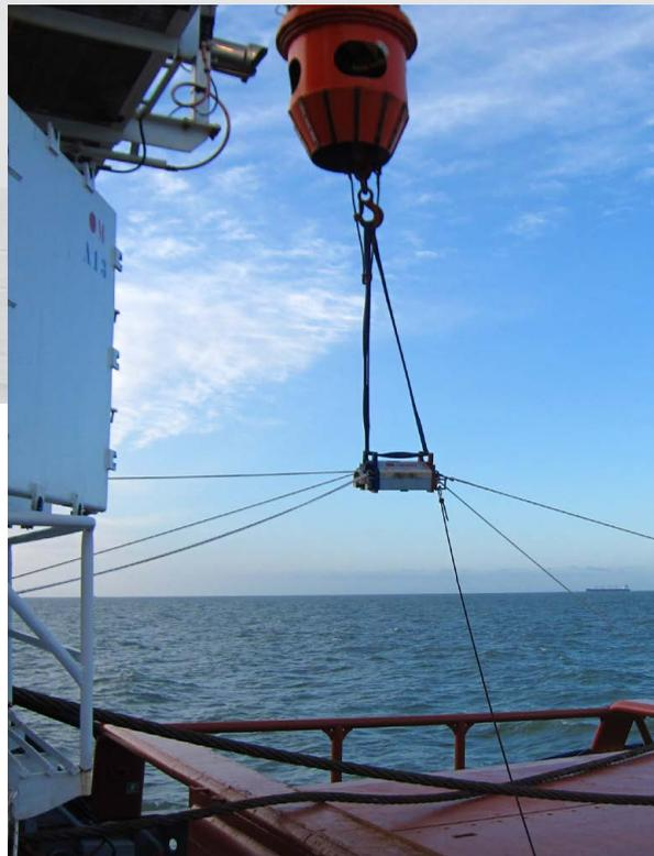
Das Seilprüfgerät wird positioniert
