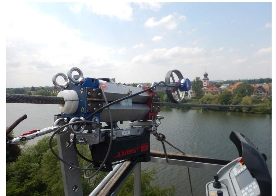
Das Tragseil der Fähre Neckarhausen wird magnetinduktiv geprüft. Dabei wurde das Prüfgerät mithilfe eines Luftkissenbootes der ansässigen Feuerwehr über den Neckar gezogen. Bild links: Regelmäßige Prüfung der Seile der Materialseilbahn von Leimen nach Nußloch
