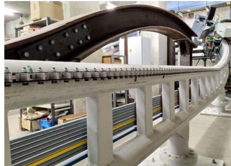
Achterbahnähnliches Bestandssystem und neues Schienenkonzepts auf Basis von Walzstahlprofilen im Hintergrund
