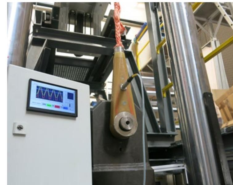
Monolithische Endverbindung mit integrierter Sensorik und Messbox zur Datenerfassung und Auswertung
