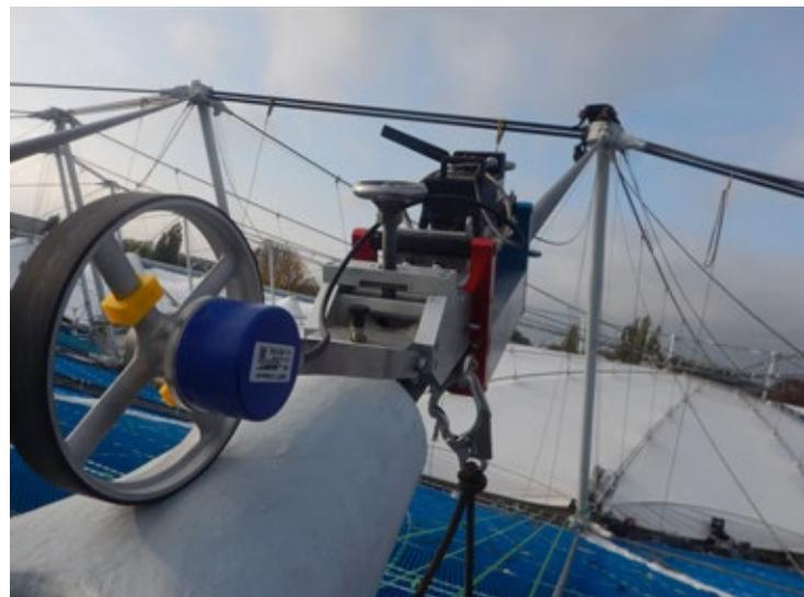
Magnetinduktives Prüfgerät SMRT 70 im Einsatz an den Radialseilen
