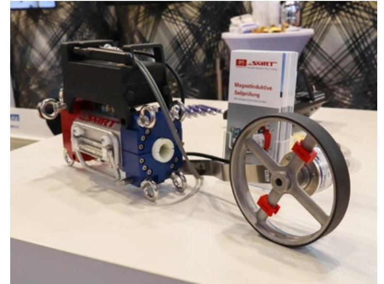
Magnetinduktives Seilprüfgerät für die Messdatenübertragung via WLAN
