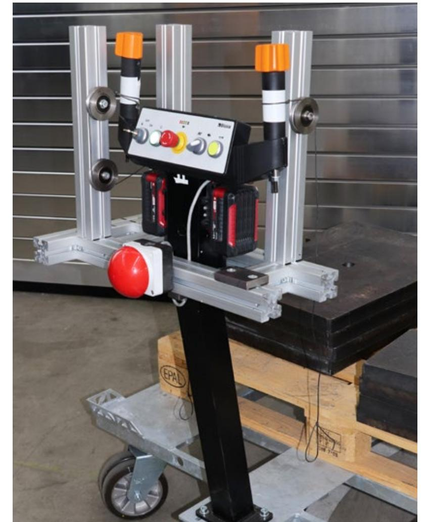
Cockpit am Prototypwagen mit Versuchsaufbau zur Aufbringung definierter Kräfte
