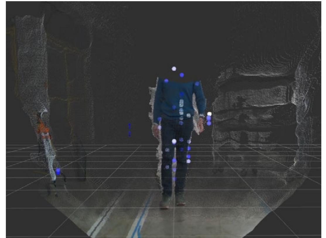
Ergebnisse einer Sensorfusion von Stereokamera und Radarsensor im Anwendungsfall der Produktionslogistik
