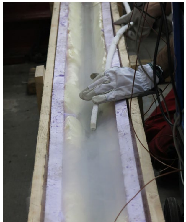
Befullen der Isolationswanne mit Flussigstickstoff
