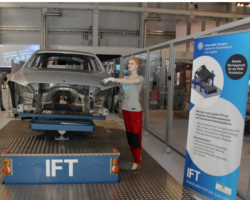
Neues Produktionskonzept: Mobile Montageinsel für die PKW-Produktion
