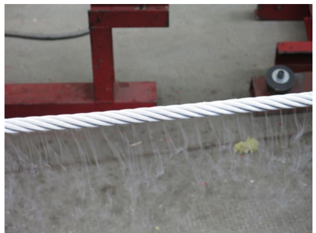
Herabgekuhltes Prufmuster bei Raumtemperatur
