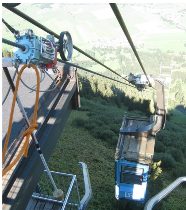
Magnetinduktives Seilprüfgerät im Einsatz
