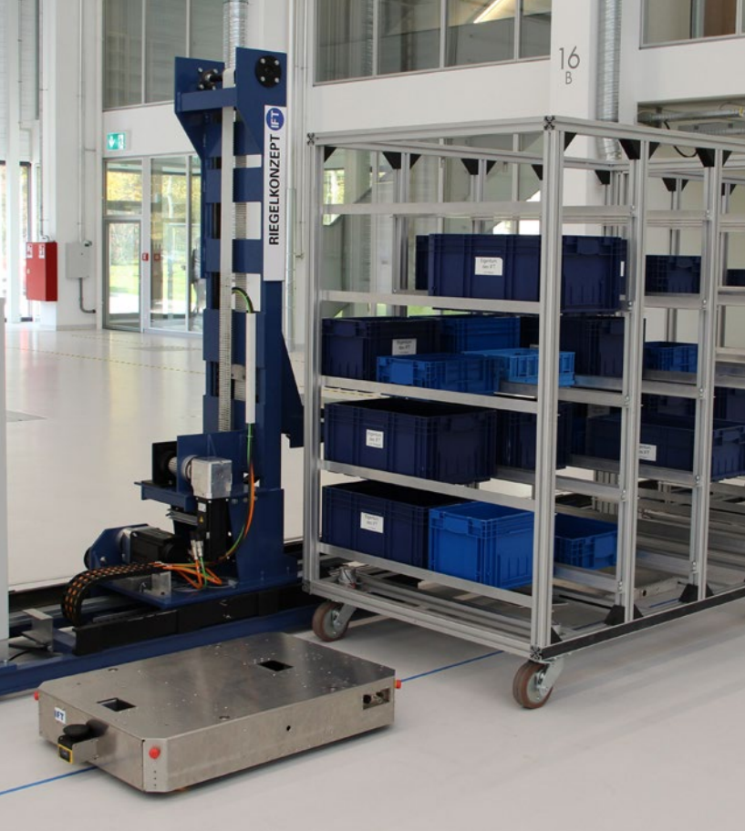
Prototypen des IFT: Mini-RBG und Klein-FTF
