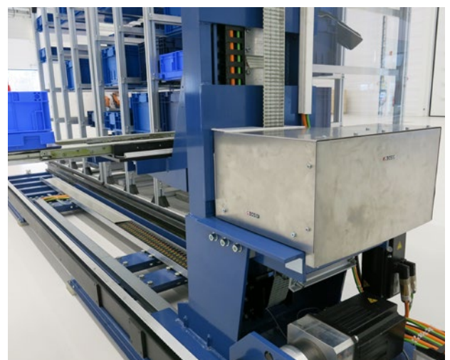
Detailansicht Hubgerüst mit Antriebseinheit
