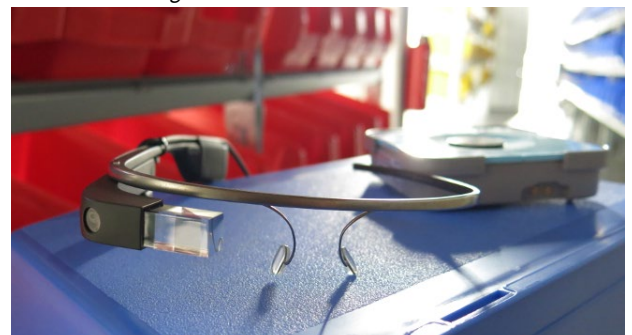
Pick-by-vision - Kommissionierung mit Datenbrille
