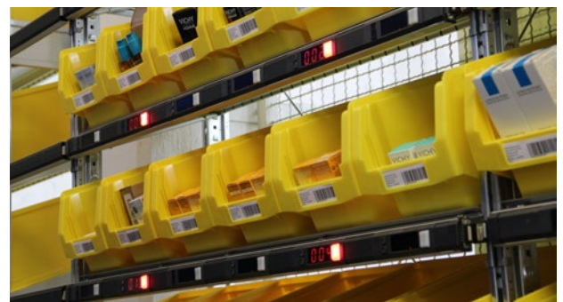
Pick-by-light - Pick-Faces zeigen den Lagerplatz und die Entnahmemenge an
