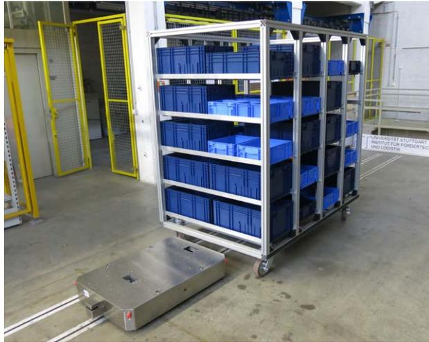
*Unterfahr-FTF beim Einfahren in den Riegel*
