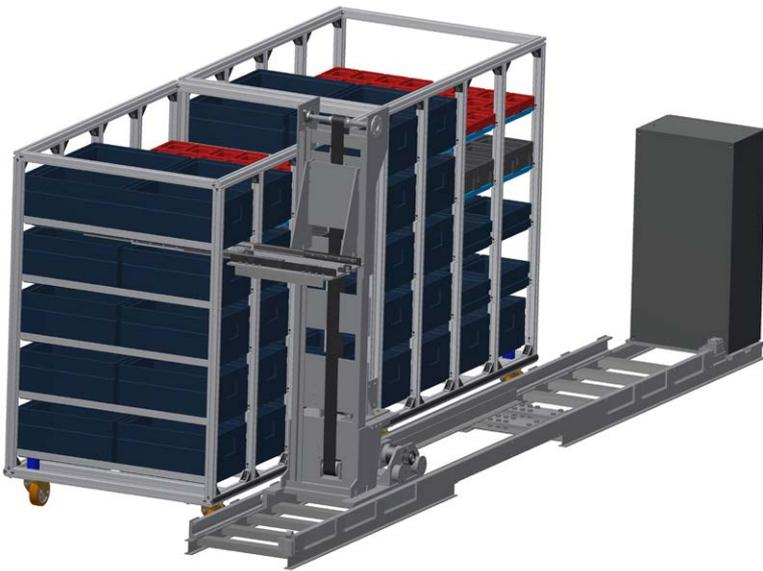
*Prototyp des mobilen schienengebundenen Mini-Regalbediengerät (RBG) mit Regal des Riegelkonzepts*
