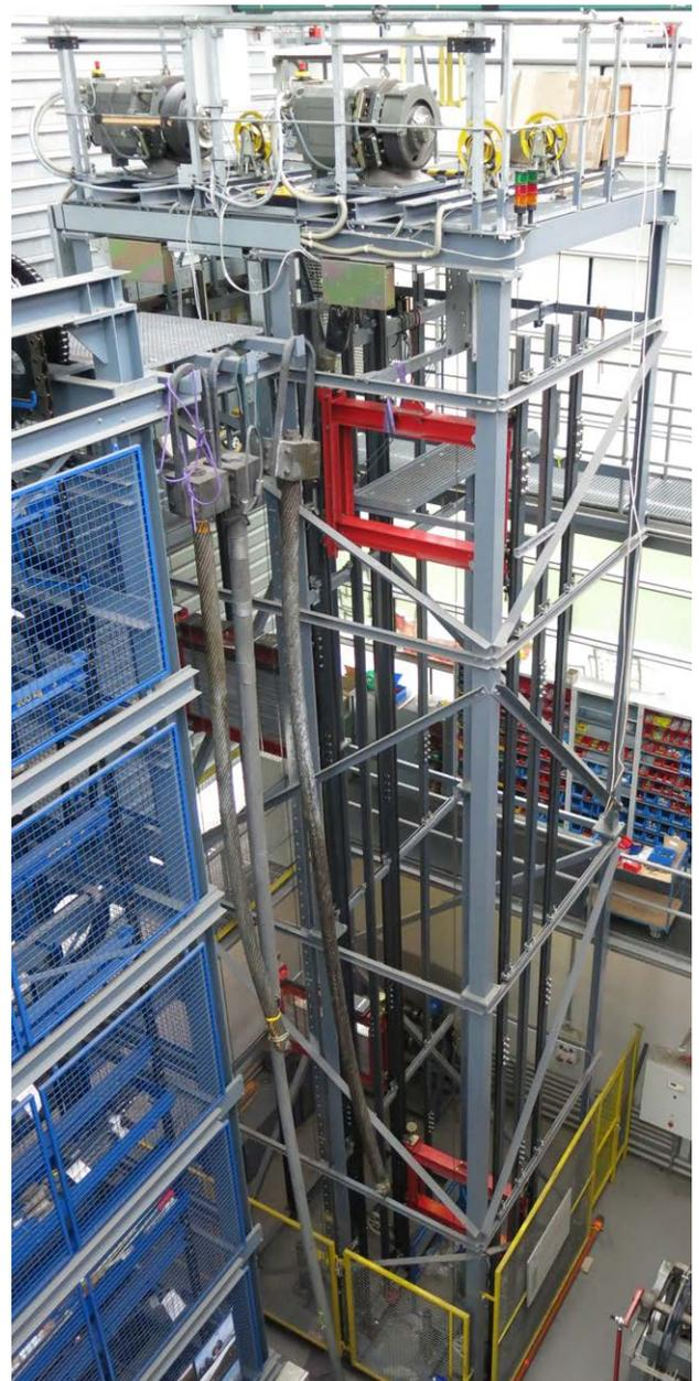
*Aufzugs- und Rillenprüfstand am IFT*
