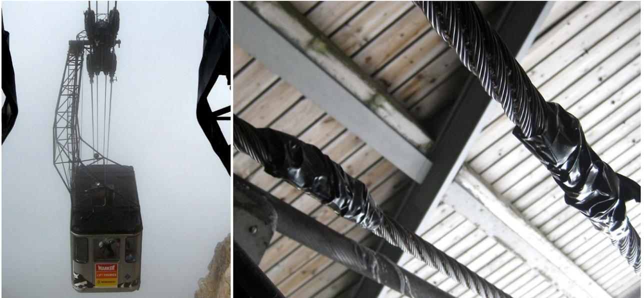
*Drehungsmessung an den parallelen Zugseilen der Eibsee-Seilbahn*
