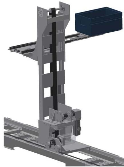
*Elemente der Regalbedieneinheit: Fahrwerk, Hubgerüst mit Hubtisch und darauf angeordnetem Horizontal-Teleskoptisch*
