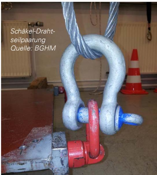
Die Versuche lassen sich in zwei Hauptgruppen unterteilen: Zugversuche um runde Bolzen (Simulation eines Kranhakens bzw. Schäkels) mit 180° Ablenkung und Zugversuche um zwei
