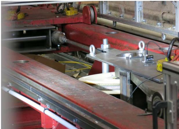
*Oben: Versuchsaufbau Zugversuch mit PA-Seilrollen unter Schrägzug*
