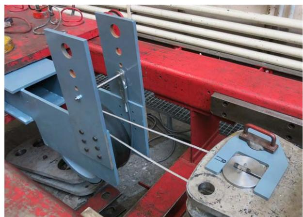
Zerreißversuch um einen Bolzen mit  $D/d = 1$  nach dem Einbau des Versuchsseiles
