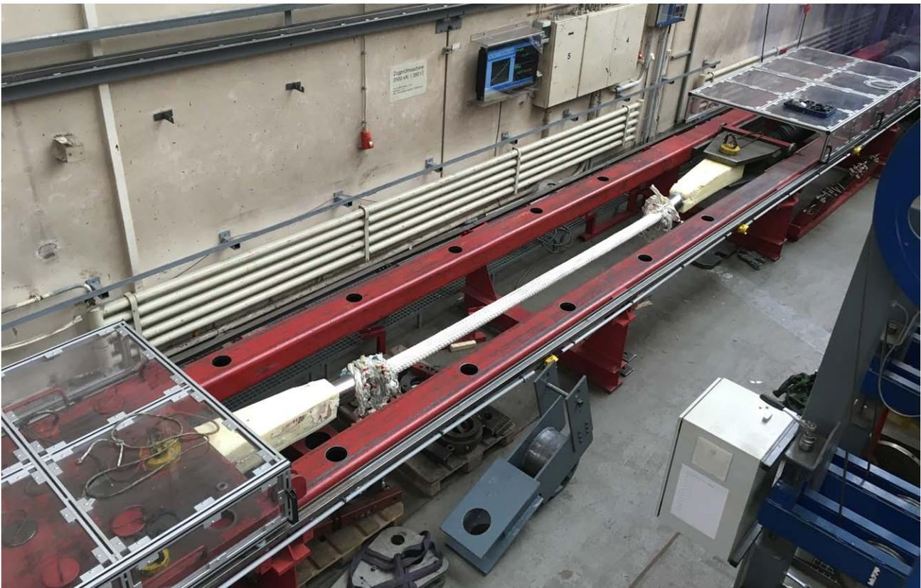
*Zerreiversuch Faserseil 96 mm mit neuen HIKE Seilendverbindungen*
