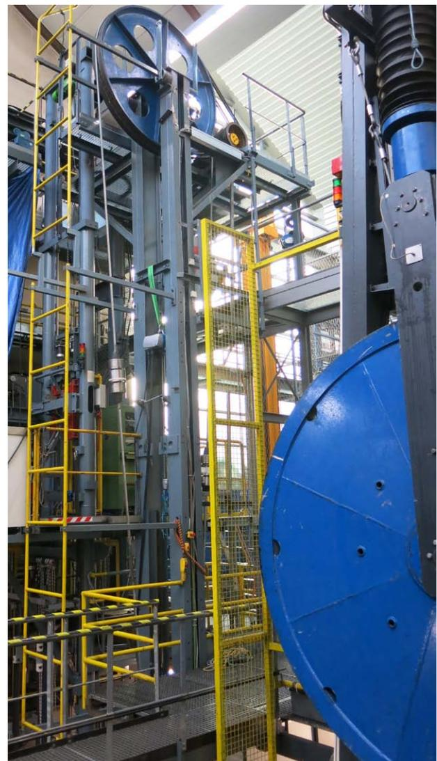
*Biegemaschine 8 mit eingebautem drehungsfreiem Kranseil*
