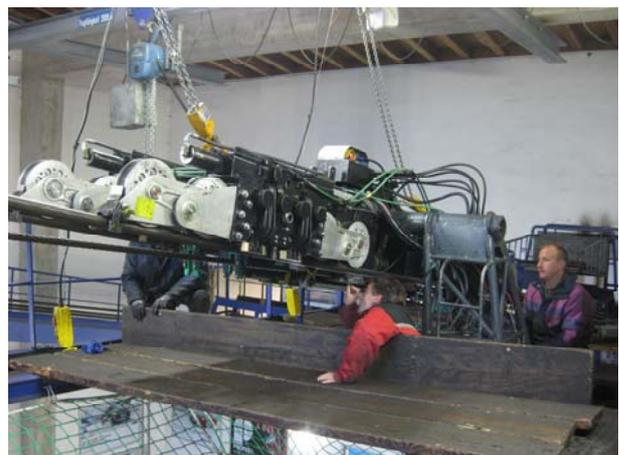
*Bild 40: IFT-Prüfingenieur bei der Begutachtung zertifizierter Seilbahnkomponenten*
