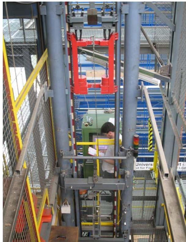
Bild 20: Der Fallprüfstand am IFT
