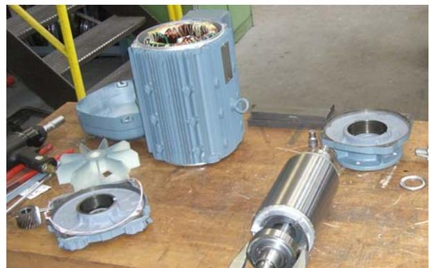
*Bild 34: Demontage von Antriebseinheiten am IFT*
