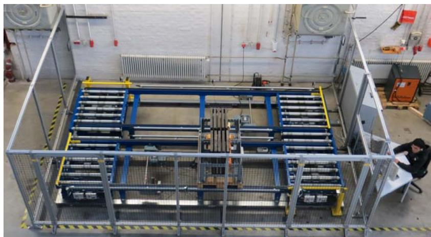
*Bild 32: Versuchsstand zur Untersuchung von Energieeffizienz von Tragkettenförderern*
