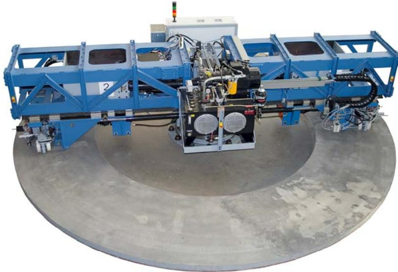
*Bild 27: Radprüfstand*
