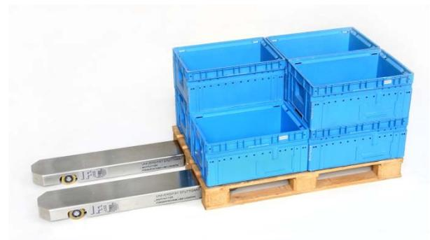
Bild 3: Doppelkufensystem zum Transport von Paletten
