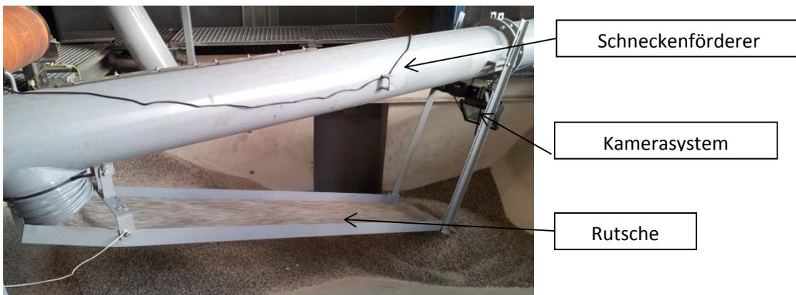
Bild 24: Integration der Rutsche in die Versuchsanlage
