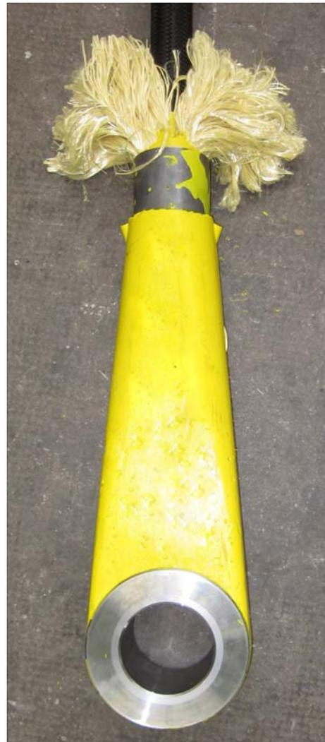
*Bild 16: Erweiterung des Seildurchmessers von 4 mm auf 50 mm*
