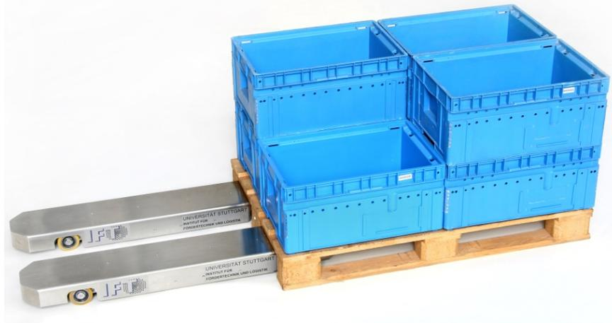
*Bild 25: Doppelkufensystem des IFT*
