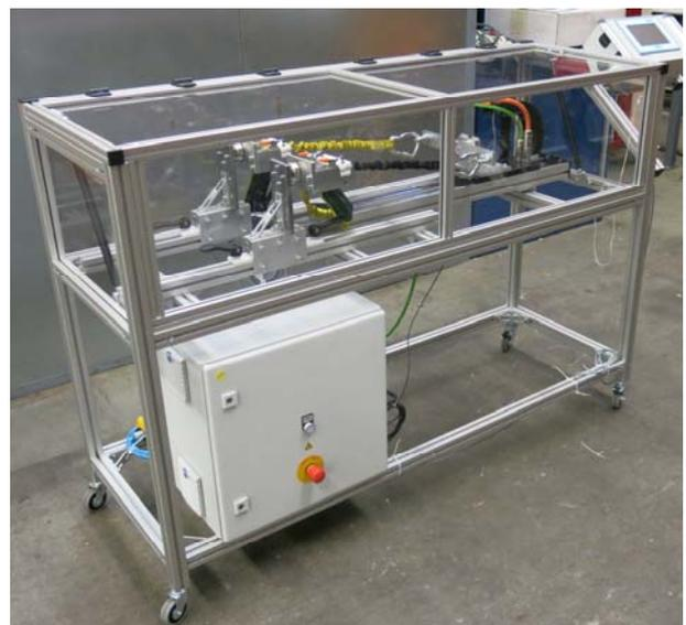
Bild 18: Prüfstand für die Prüfung der elastischen Y-Arme von Klettersteigsets
