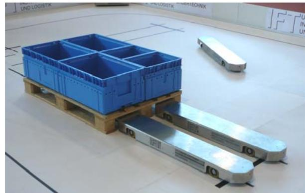
*Bild 29: Doppelkufensystem des IFT*
