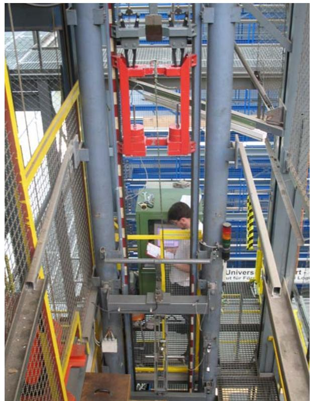
Bild 25: Der Fallprüfstand am IFT
