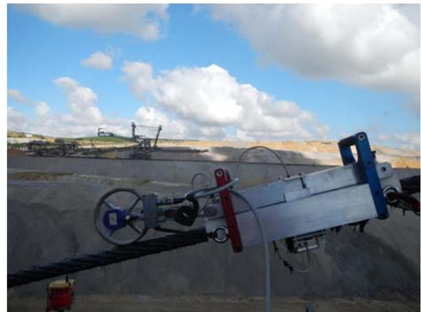
Bild 15: Magnetinduktive Seilprüfung im Tagebau
