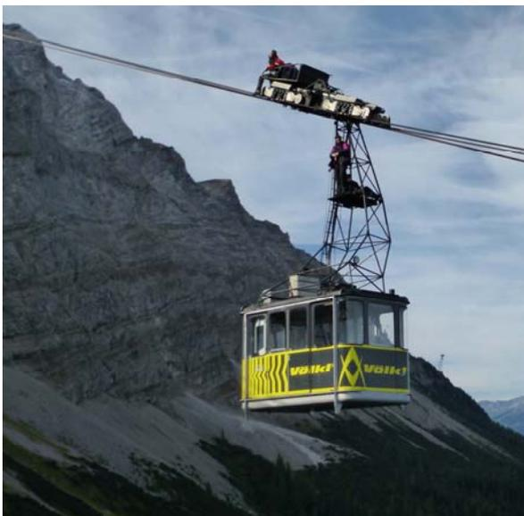
*Bild 7: Seilprüfung der Eibseebahn zur Zugspitze*
