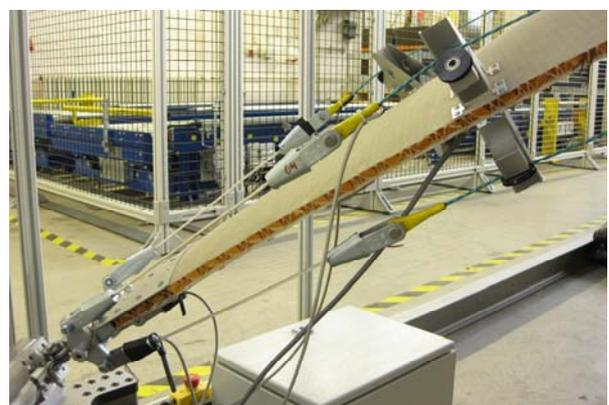
*Bild 19: Anordnung der Randzugelemente im Demonstrator*
