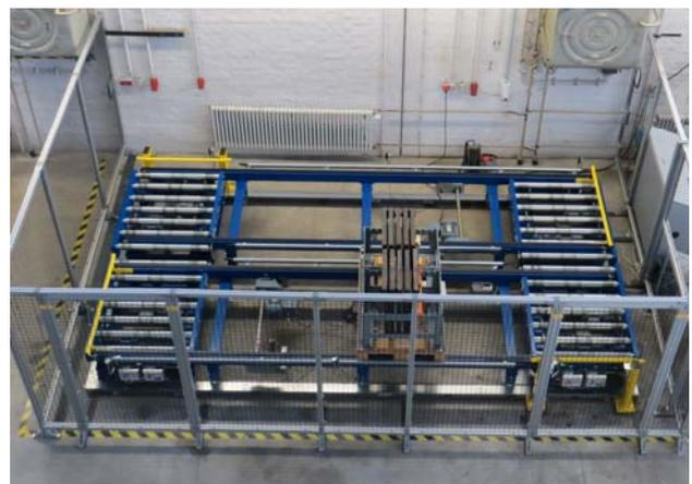
*Bild 34: ELKoB: Versuchsstand zur Untersuchung von Energieeffizienz von Tragkettenförderern*
