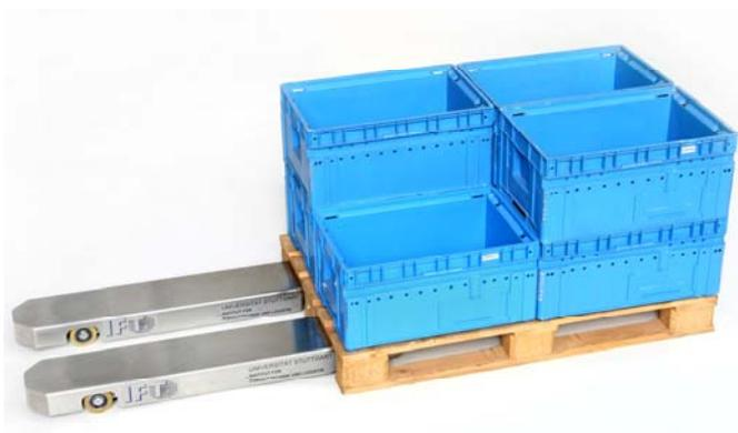
*Bild 4: Doppelkufensystem zum Transport von Paletten*
