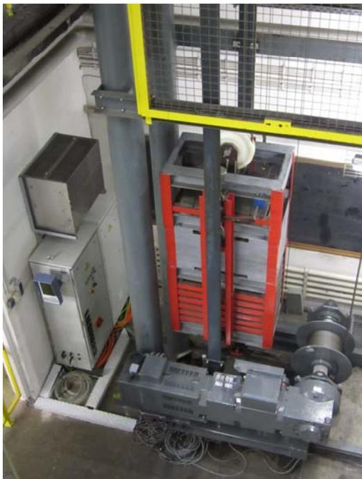
Bild 22: Neuer Prüfstand Mehrlagenwicklung
