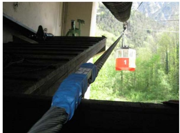
*Bild 10: Drehsensortest, Predigtstuhlbahn Bad Reichenhall*
