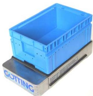
*Bild 5: Kleine automatische Transporeinheiten (KaTe) zum Transport von KLT*
