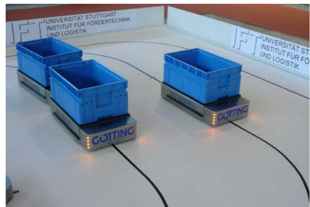
*Bild 31: Spurführung der Kleinen automatische Transporteinheiten (KaTe) auf einer Versuchsfläche*
