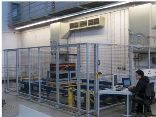
*Bild 6: Versuchsstand zur Untersuchung von Energieeffizienz von Tragkettenförderern im Rahmen des Projekts ELKoB*
