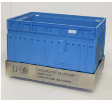
Bild 3: KaTe: Transportfahrzeug für KLT Behälter
