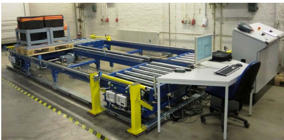
Bild 38: Versuchsstand zur Untersuchung von Energieeffizienz von Kettenförderern
