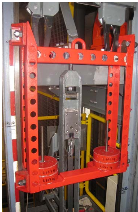
Bild 26: Fallprüfstand, konfiguriert für 48 kg
