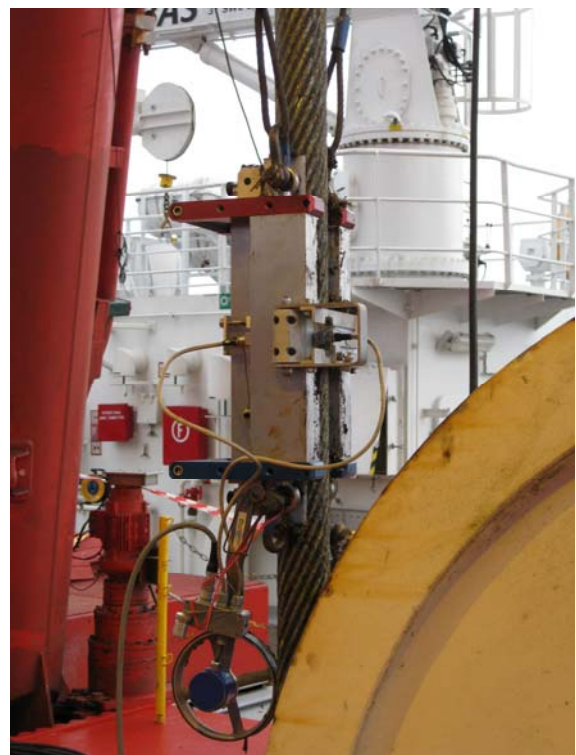
Bild 5: Die Kranseile des Verlegerschiffs Scandy Acergy werden auf hoher See geprüft.
