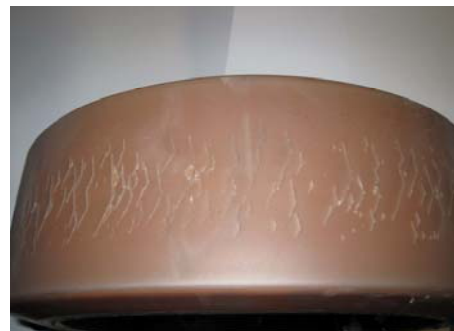
Bild 32: Rissbildung an einem Prüfrad
