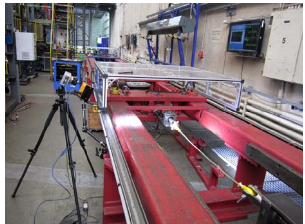
Bild 23: Hochgeschwindigkeitsaufnahme zur Untersuchung des Schadensverlaufs beim Zugversuch mit neuartiger HIKE-Endverbindung
