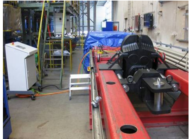
Bild 21: Verdrehvorrichtung der Drehmomentmesseinrichtung für 10.000 Nm
