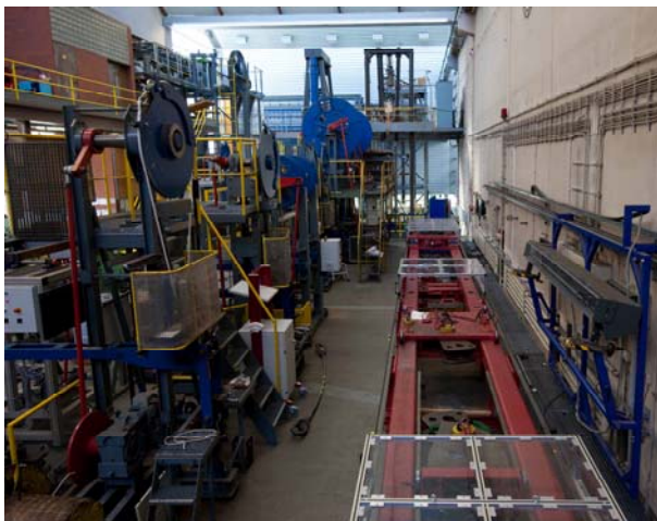
Bild 13: Seillabor des IFT mit Biege- und Zugprüfmaschinen
