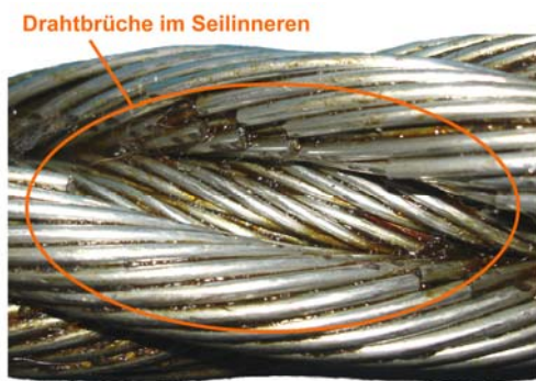
Bild 15: Litzenseil mit Drahtbrüchen an den Drahtkontaktpunkten
