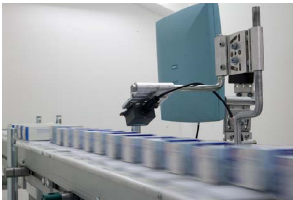
Bild 33: Versuchsstand für die Identifikation von Einzelverpackungen
