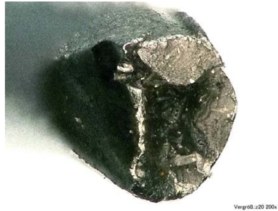
Bild 21: Frontalansicht des Drahtbruchs
