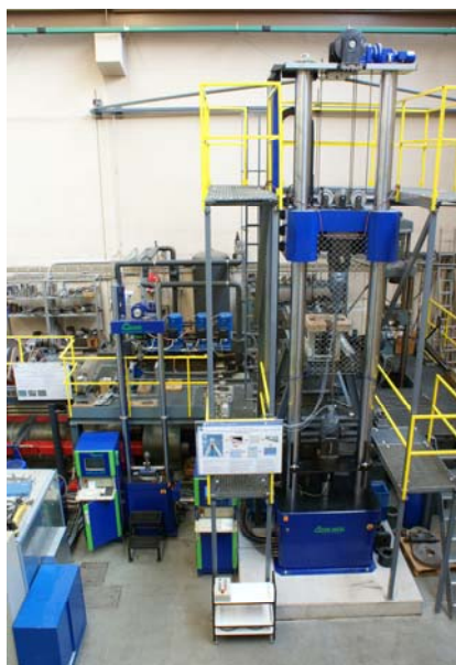
Bild 8: Prüfmaschinen für Zug- und Zugschwellversuche
