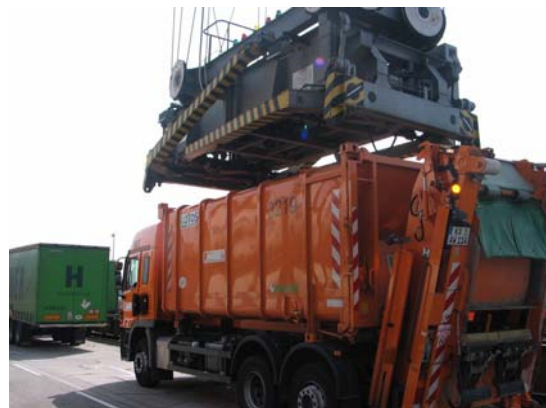
Bild 41: Abnahme eines Abfallcontainers mittels Spreader; Quelle: Haller Umweltsysteme GmbH & Co.
