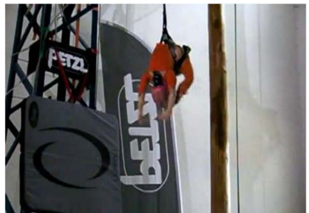
Bild 11: Fallprüfungen von Klettersteigbremsen an Crash-Test-Dummies
