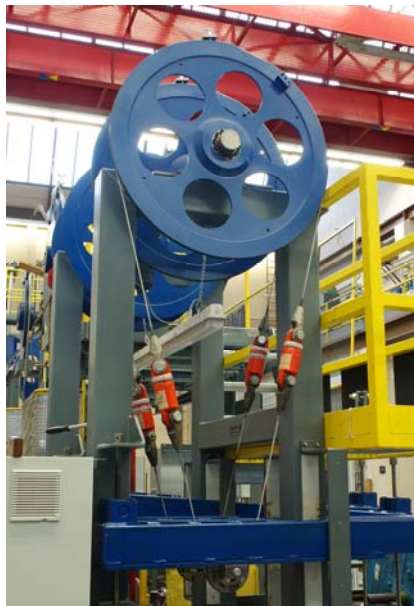
Bild 7: : Dauerbiegemaschine mit einer Seilzugkraft von 4 x 15 kN
