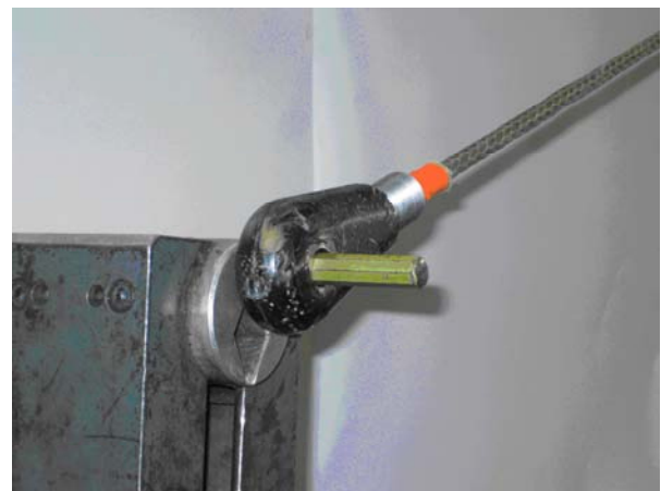
Bild 14: Neuartige Endverbindung für Faserseile
