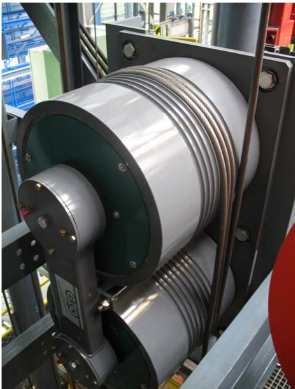
Bild 12: Zusatz- Spillwinde zur Zugkraftaufnahme
