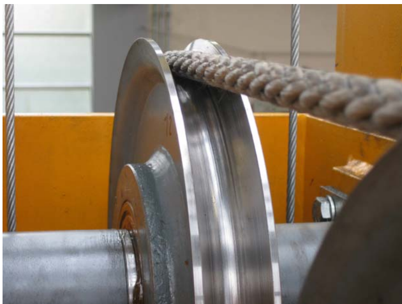
Bild 9: Prüfung eines hochfesten Faserseils
