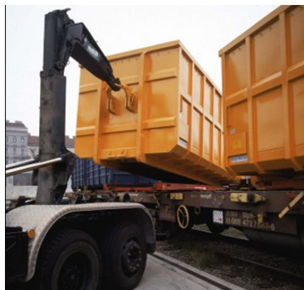
Bild 40: Abfallcontainerverladung über das Abrollcontainer-Transportsystem Quelle: Rail Cargo Austria
