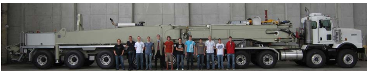
Bild 53: Die Exkursionsteilnehmer vor dem 10-Achs-Semitrailer-Chassis einer Autobetonpumpe
