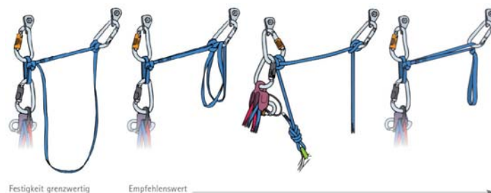
Bild 15: DAV-Lehrmeinung zum sicheren Bau von Standplätzen im Bergsport (Auszug)
