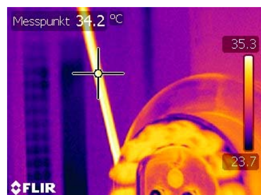
Bild 20: Drahtseil während des Biegeversuchs
