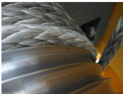
Bild 12: RBG-Seiltrommel mit hochfestem Faserseil
