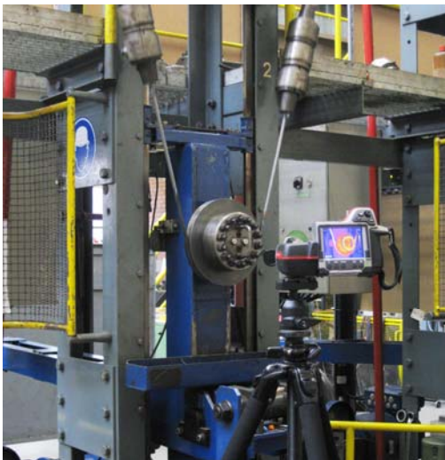
Bild 18: Wärmebildkamera im Einsatz beim Biegeversuchen
