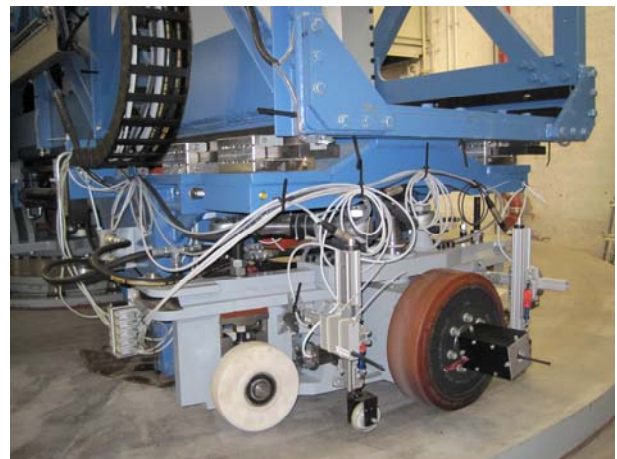
Bild 29: Detail: Prüfrad mit messtechnischen Komponenten
