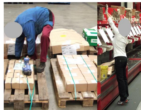
Bild 32: Mangelhafte Arbeitsplatzgestaltung in der Kommissionierung und in der Packerei
