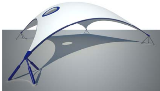
Bild 21: Das Schalentragwerk aus neuen hybriden intelligenten Konstruktionselementen passt sich selbstständig an Umwelteinflüsse an. (Grafik: Institut für Leichtbau, Entwerfen und Konstruieren ILEK)
