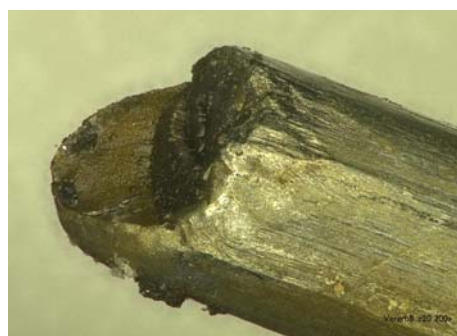
Bild 11: Ermüdungsbruch bei 200-facher Vergrößerung
