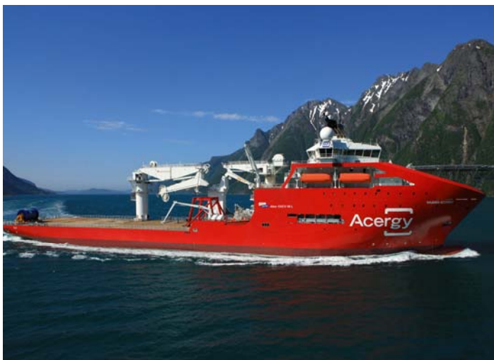
Abb. 24: Montageschiff Skandi Acergy mit 400 t-Kran
