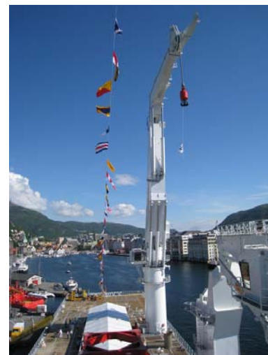
Abb. 25: 400 t-Kran und Montagedeck im Detail
