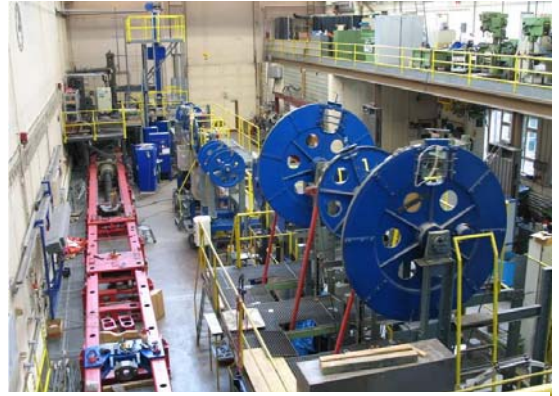
Abb. 12: Zerstörende Seilprüfung am IFT
