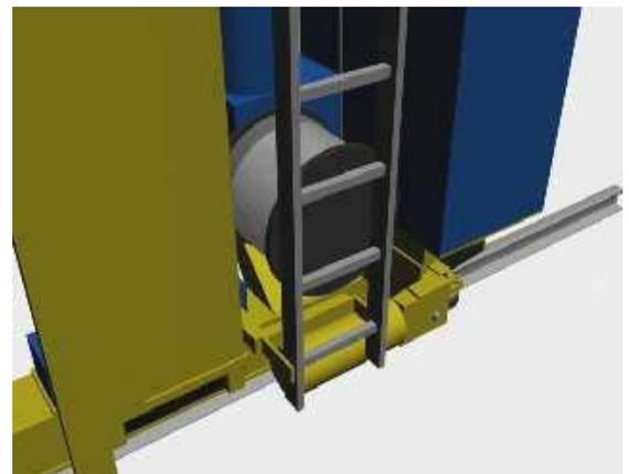
Abb. 79: 3D-Modell eines Seiltriebes im Regalbediengerät
