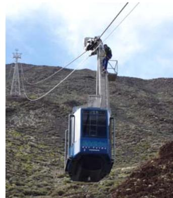
Abb. 13: Magnetische Seilprüfung am „Teleferico del Teide“
