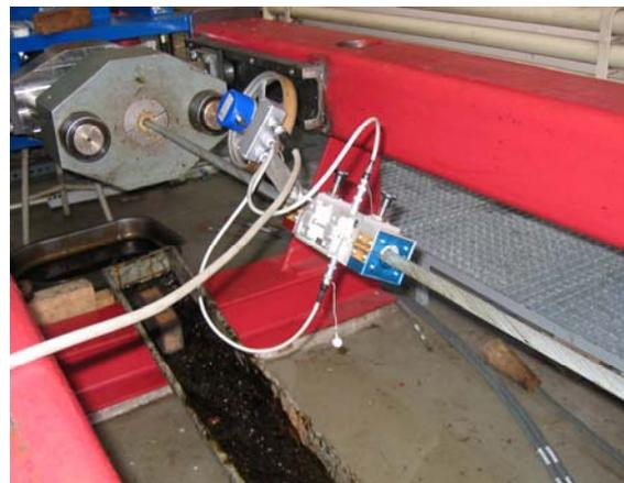
Abb. 17: Magnetische Seilprüfung an einem zugschwellbelasteten Seil
