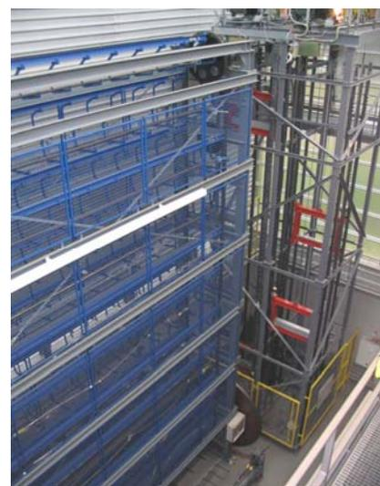
*Abb. 4: Paternosterlager für Kalibrier- und Prüfseile (vorn); Versuchsstand „Rillenprofile“ (hinten)*
