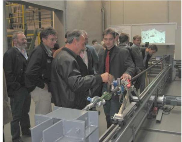
*Abb. 5: Neuer Prüfstand für die magnet-induktive Seilprüfung*
