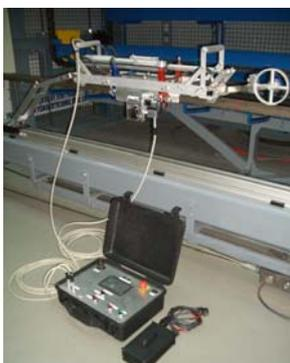
Abb. 15: Öffnungs- und Abhebeeinrichtung
