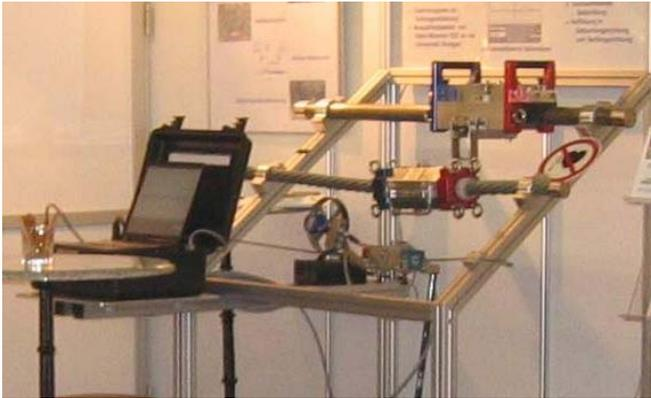
*Abb. 74: Die 3 Magnetinduktiven Seilprüfgeräte
