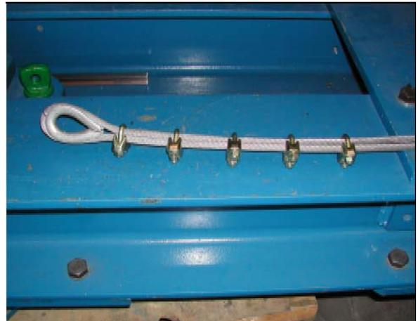
Abb. 51: Drahtseilklemme nach DIN 1142
