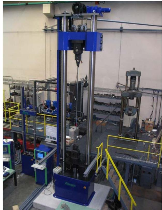
Abb. 12: Zugschwellprüfung eines Seiles
