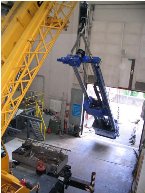
Abb. 11: Aufbau des 800 kN Pulsators
