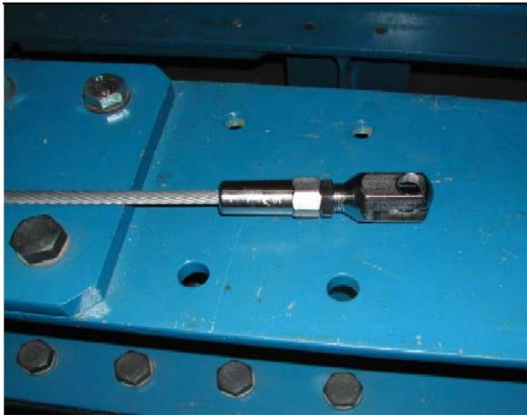
Abb. 50: Schraubterminal
