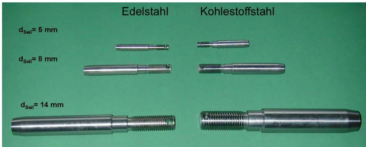
Abb. 14: Presshülsen für die Seilennendurchmesser  $d = 5, 8$  und  $14$  mm
