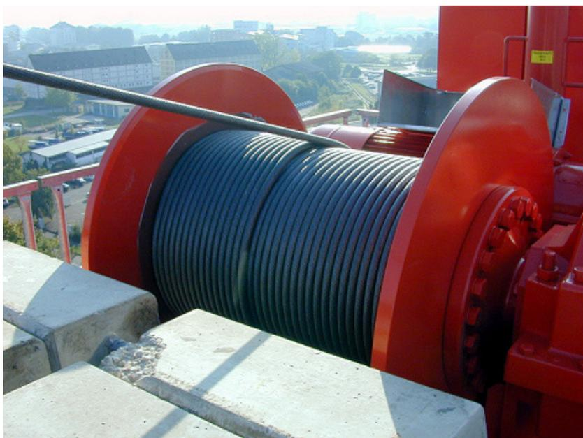
*Abb. 15: Hubwinde eines Turmdrehkrans mit Mehrlagenwicklung*
