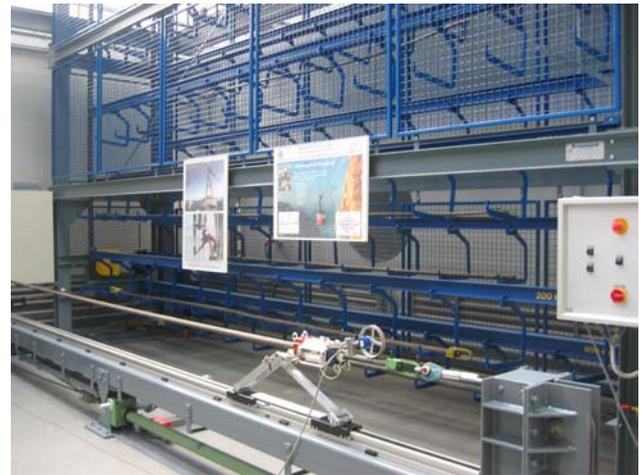
Abb. 59: Paternosterlager für Kalibrierseile der Magnetinduktiven Prüfgeräte
