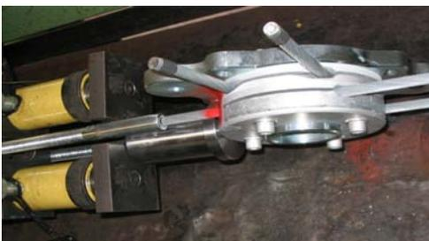
*Abb. 46: Ermittlung der Grenzgleitkraft*
