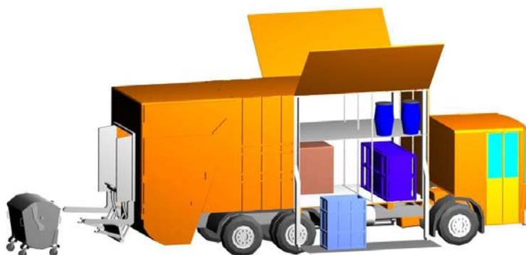
Abb. 58: Fahrzeugkonzept mit geteiltem Aufbau
