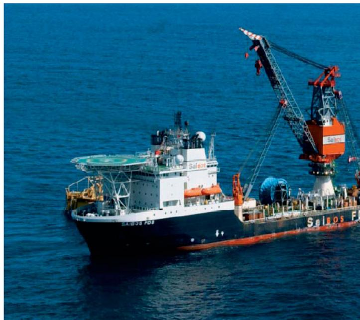
*Abb. 18: Spezialschiff mit 400 t Arbeitskran für das pipe laying in großer Meerestiefe*
