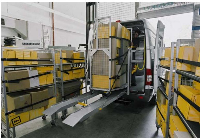
**Abb. 15** ...und Verfahren der Regalmodule ins Fahrzeug
