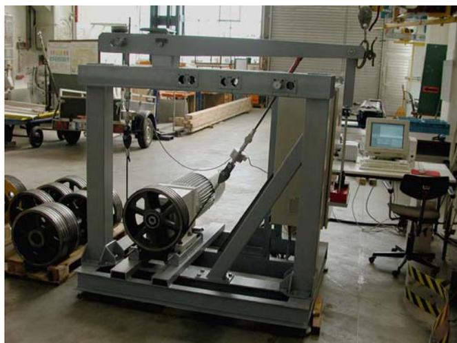
**Abb. 21** Der Treibfähigkeitsprüfstand –
