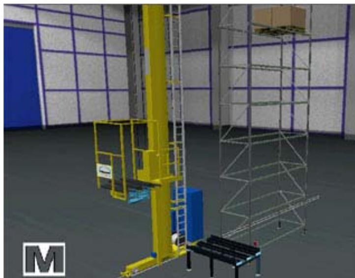
**Abb. 50** 3D-Modell Regalbediengerät auf der Lernplattform Logedugate
