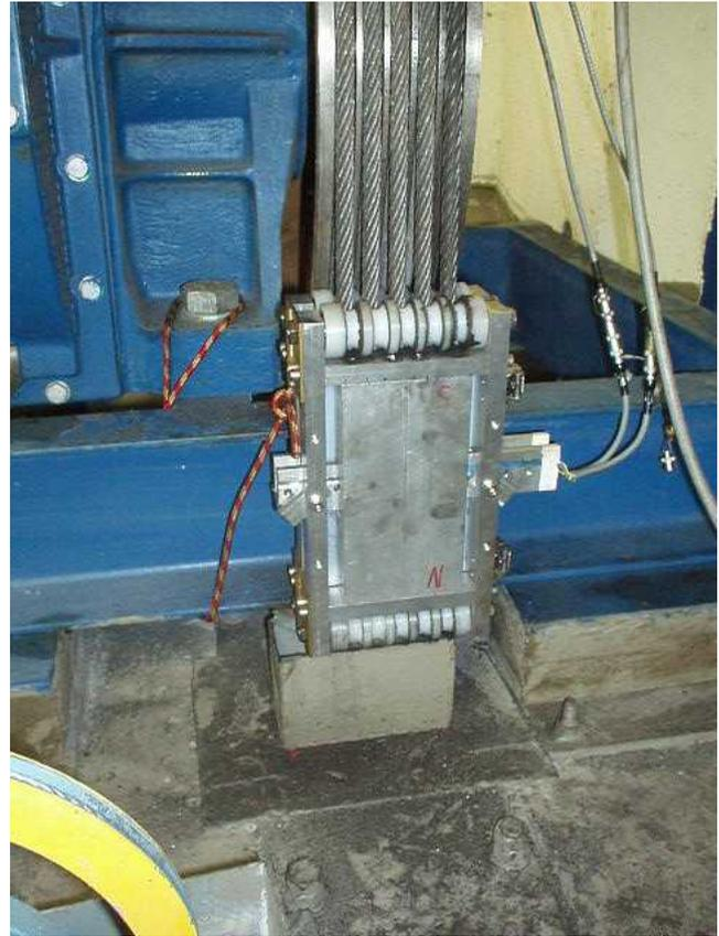
**Abb. 35** Prüfgerät für Aufzugsanlagen
