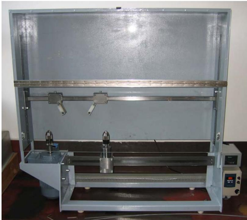
**Abb. 26** Zusätzlich eingesetzte Stuttgarter Drahtumlaufbiegemaschine für das Forschungsprojekt Drahtziehgüte
