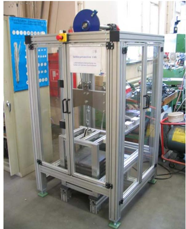
**Abb. 29** Seildauerbiegemaschine für kleine Seildurchmesser (Ausführung Delphi)
