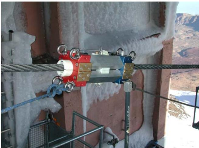
**Abb. 31** Magnetinduktive Prüfung des Zugseils
