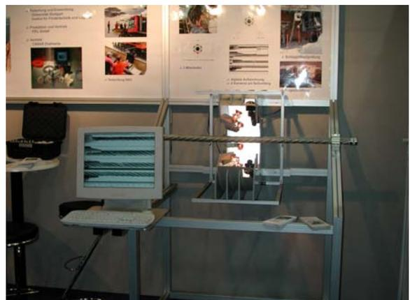
**Abb. 65** Prototypensystem zur visuellen Seilkontrolle
