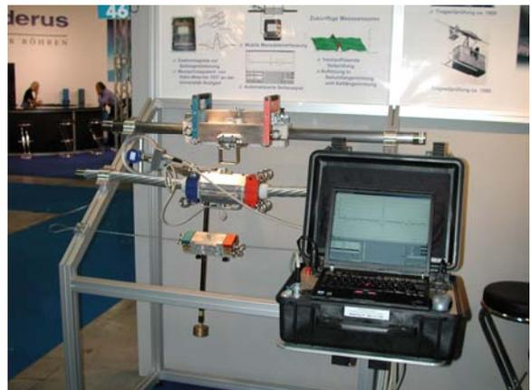
**Abb. 64** Mobiles Seilprüfgerät mit den Magneteinheiten CMRT 16, 40, 60
