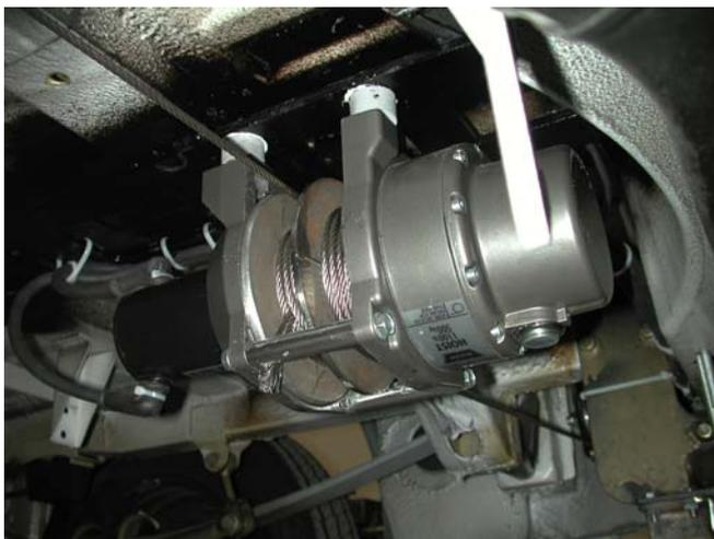
**Abb. 46** Seilwinde mit doppelter Trommel
