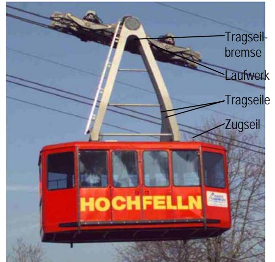
**Abb. 23** Pendelbahnen mit Tragseilbremse
