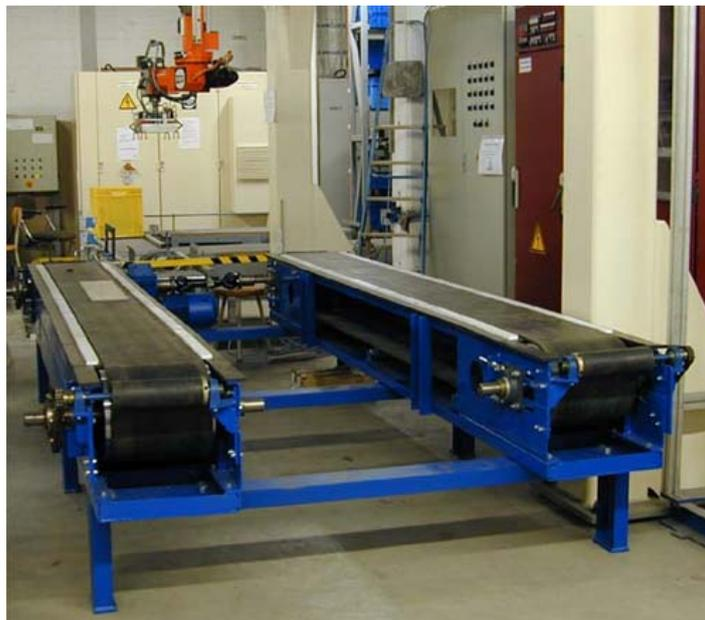
**Abb. 52** Versuchsaufbau des Bandförderers im Labor für Fördertechnik
