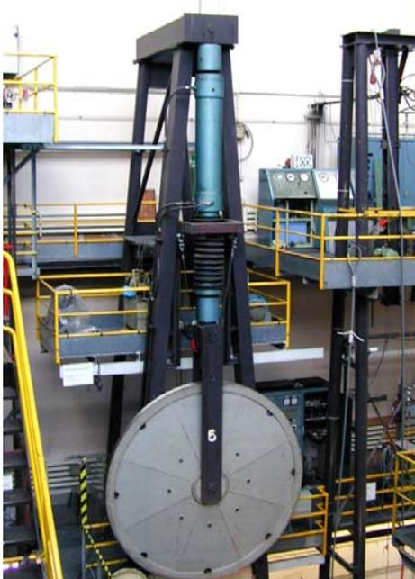
**Abb. 18** Dauerbiegemaschine 5
