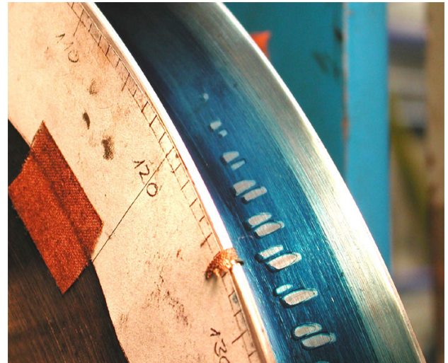
Abb. 18 Ermittlung des Auflaufpunkts an der Rillenflanke
