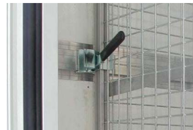
Abb. 37 Befestigung der Regalmodule im Fahrzeug
