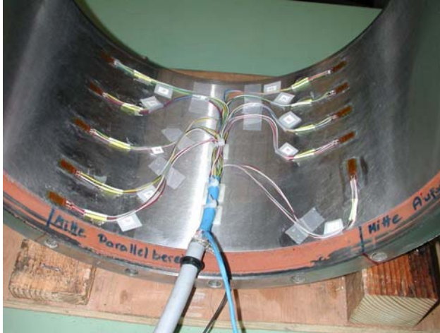
Abb. 23 Trommelmantel, mit Dehnmessstreifen präpariert und verkabelt; links DMS im Parallelbereich, rechts DMS im Steigungsbereich der Rillung
