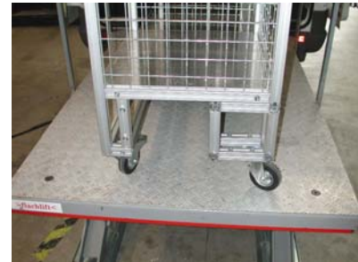
Abb. 35 Mechanismus zur Lösung des Radkastenproblems – Pos.1: Stellung der Räder, wenn das Modul bewegt wird
