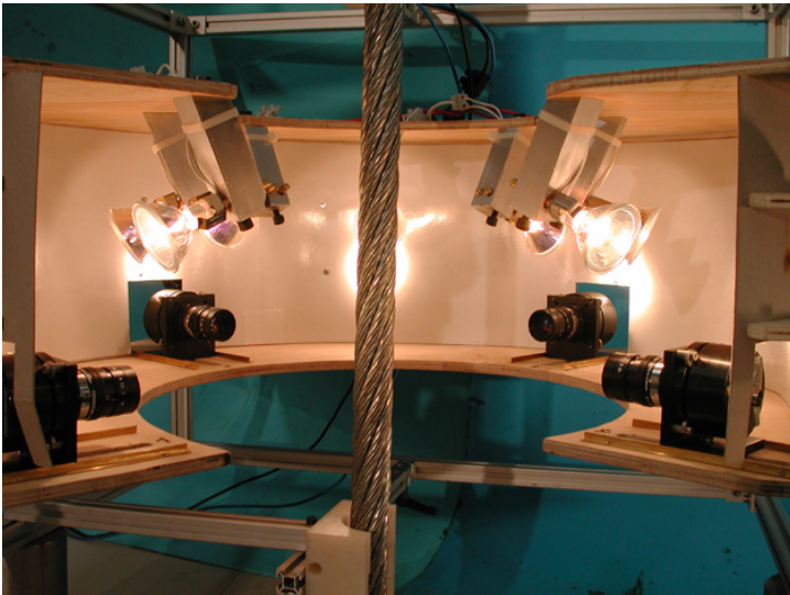
Abb. 30 Versuchsanordnung der neuen visuellen Seilprüfung
