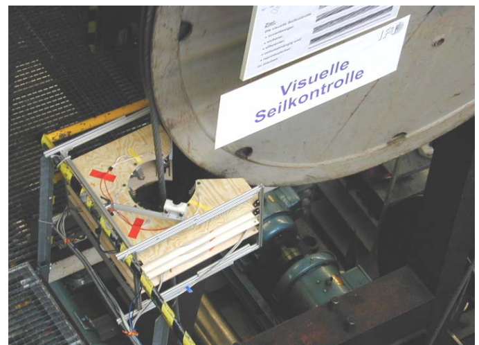
Abb. 7 Versuchsaufbau der visuellen Seilprüfung
