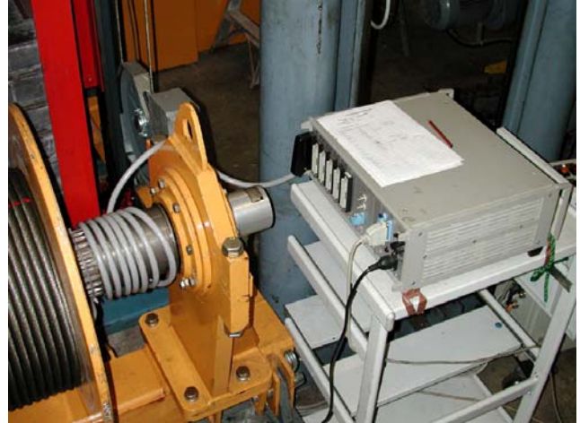
Abb. 24 Messaufbau zur Spannungsmessung am Prüfstand
