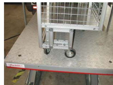
Abb. 36 Pos.2: Stellung der Modulräder im Fahrzeug über den Radkästen
