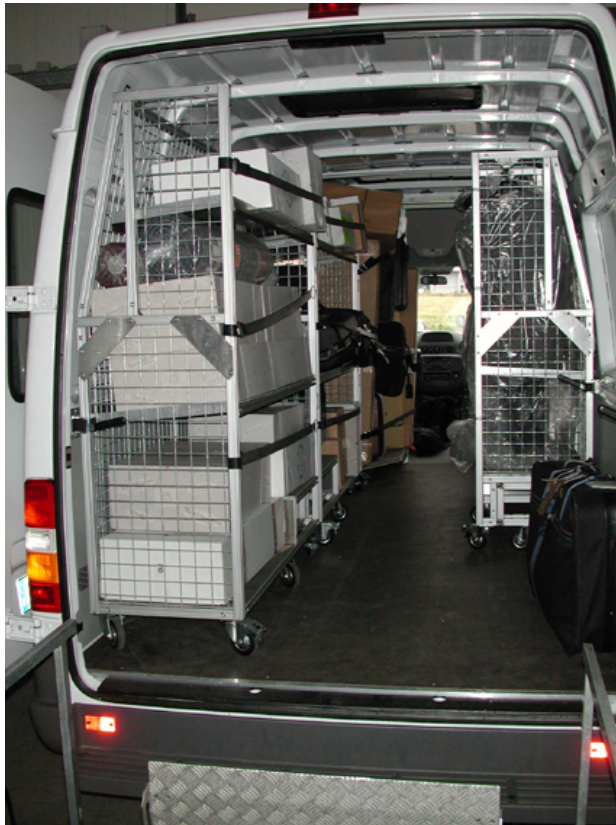
Abb. 34 An die Fahrzeugkontur angepasste Regalmodule
