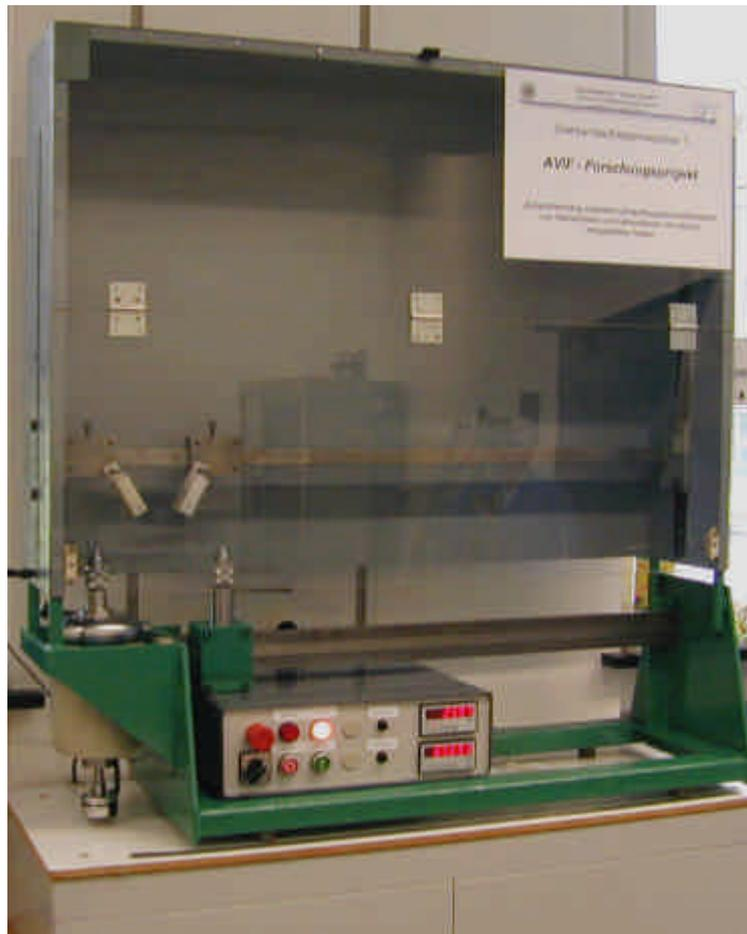
**Bild 6** Stuttgarter Drahtumlaufbiegemaschine 2001
