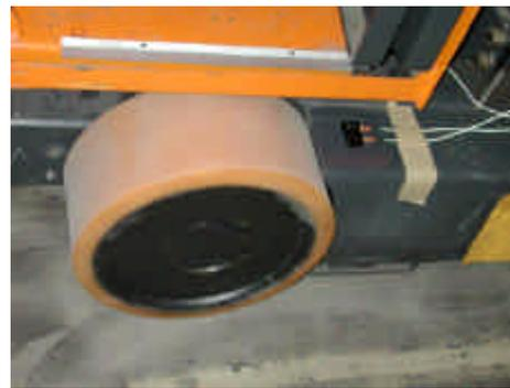
**Bild 27** Kommissionierstapler mit Triblexmast MX 15- 3-Prototyp bei Fa. Still Wagner (links) und Anbringung der Beschleunigungssensoren (rechts)
