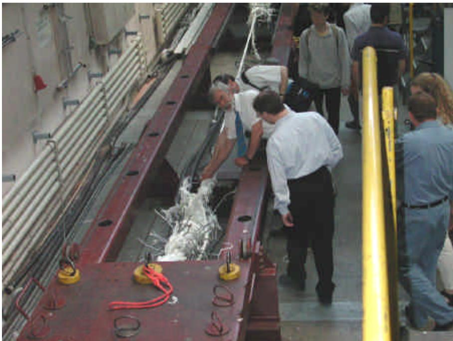
**Bild 45** ZerreiBversuch an einem Schiffstau
