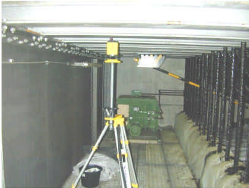
**Bild 31** Verformungsmessung vor Ort an den Seilscheibenträgern
