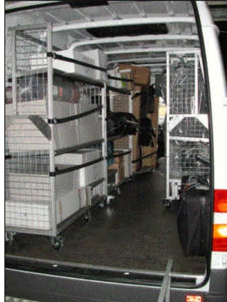
**Bild 24** Regalmodule im Verteilfahrzeug
