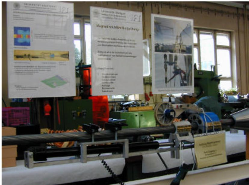
**Bild 29** Magnetprüfgerät zur zerstörungsfreien Prüfung von Seilendverbindungen
