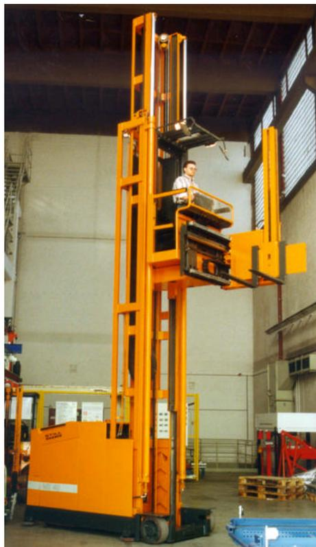
**Bild 30** Drei-Seiten-Kommissionierstapler für die Schwingungsmessung
