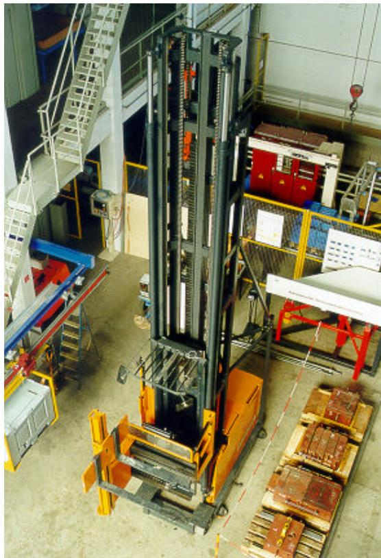
**Bild 19** Kommissionierstapler mit 14 m Hubhöhe
