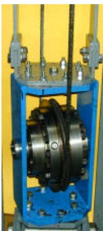
**Bild 12** Verdrehung der Seilscheibe um die Längsachse
