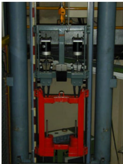
**Bild 11** Fallprüfstand - Fallmasse mit zugehörigem Hebeschlitten
