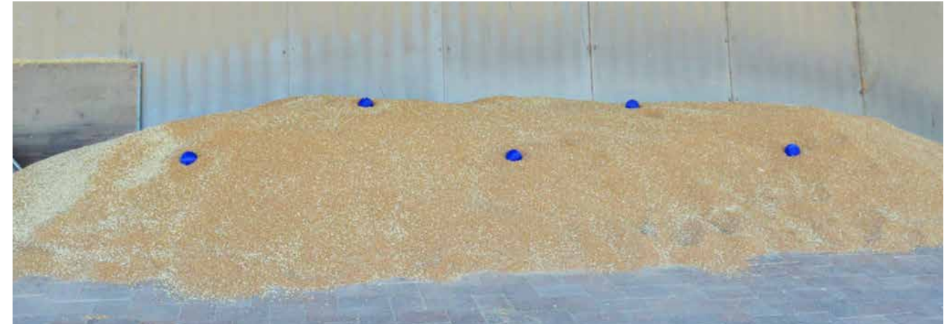
Anordnung zur Erprobung: Während des Versuchs waren die Sensoreinheiten im Getreide versenkt.
