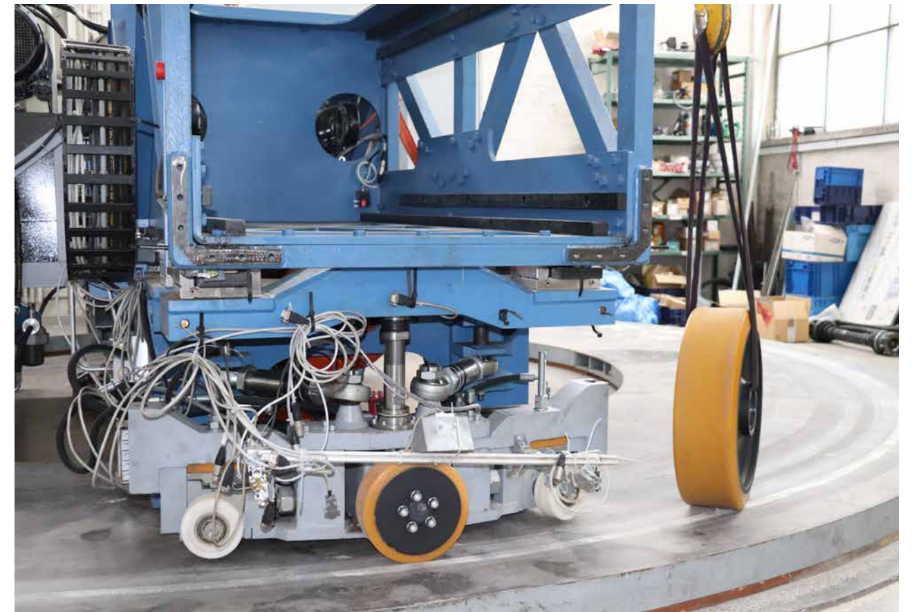
Konzipiert für Radgrößen von 230 bis 400 mm, können durch Umbauten auch Räder mit Größen von 500 mm mit verschiedenen Parametern auf dem Prüfstand untersucht werden.
