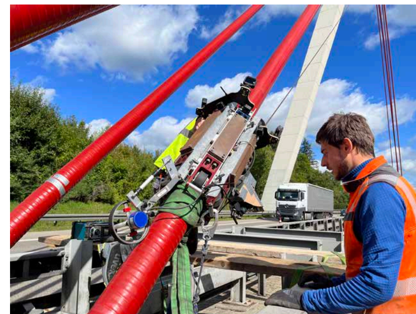
Kombinierte magnetinduktive und visuelle Seilprüfung der Schrägseilbrücke Obere Argen
