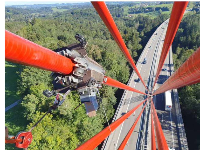
Kombinierte magnetinduktive und visuelle Seilprüfung der Schrägseilbrücke Obere Argen
