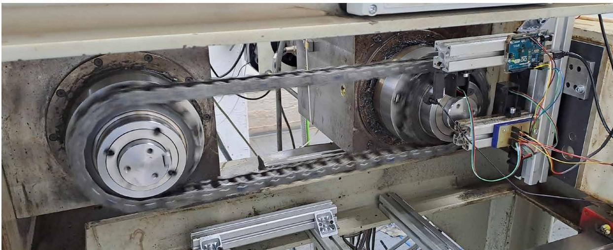
Temperaturmessung am Kettentrieb. Vor dem rechten Kettenrad ist der Messaufbau befestigt, zwei kontaktlose Temperatursensoren messen regelmäßig die Kettentemperatur, zwei Widerstandsthermometer messen zusätzlich die Umgebungstemperatur als Referenzwert.
