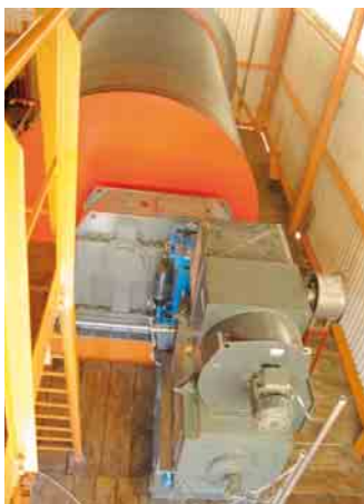
2 Hubwerksantrieb mit Trommel
