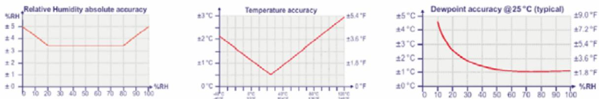
**Bild 10:** Messgenauigkeit des EL-USB-2
