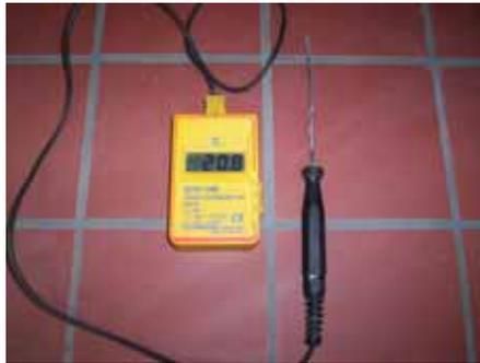
**Bild 10:** Temperaturmessfühler
