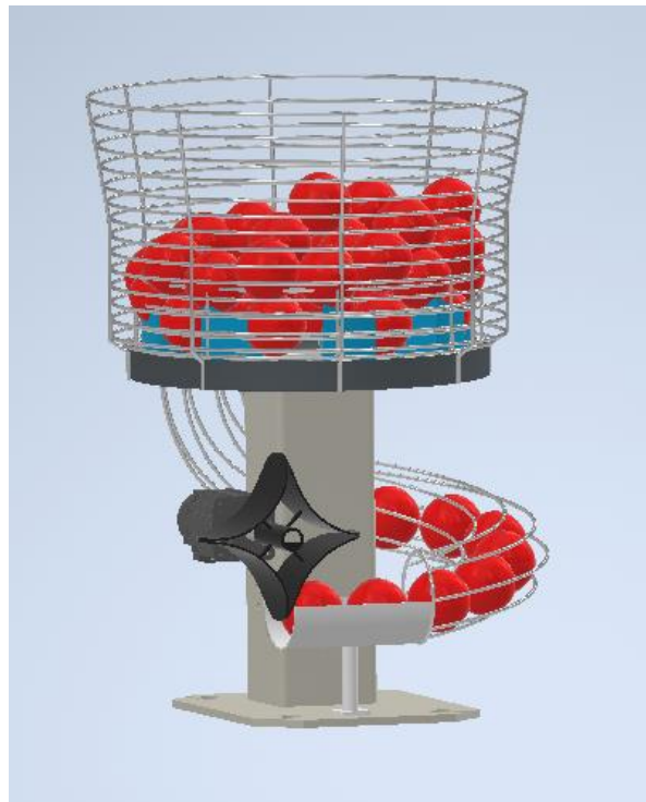
Abbildung 33: System zur automatisierten Einbringung der Sensorkugeln während des Einstapelns
