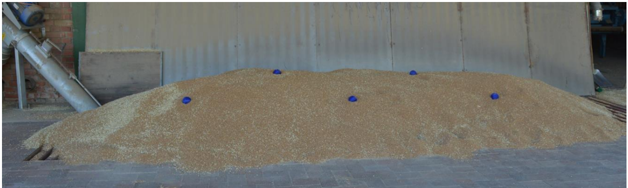
Abbildung 10: Versuchsaufbau der Erprobung in Weizen. Die Lage der Sensorkugeln an der Oberfläche dient lediglich der Veranschaulichung, im Versuch waren die Kugeln ca. 30-50 cm tief im Getreide versenkt.
