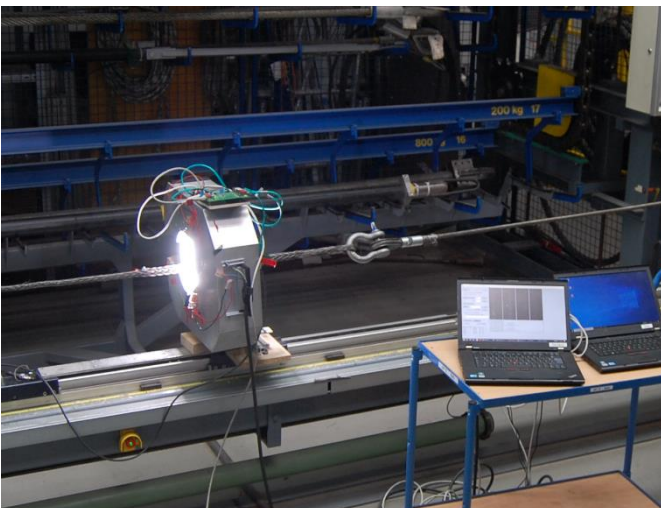
Visuelles Prüfgerät zur Überwachung von laufenden hochfesten Faserseilen
